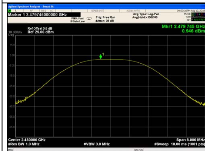
AV Output power - High CH 2480
