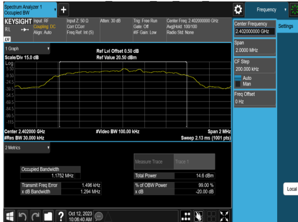
IC OBW 99% 8DPSK 3M DH5 2441MHz
