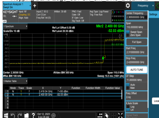
Hopping Band Edge 8DPSK 3M DH5 2480MHz
