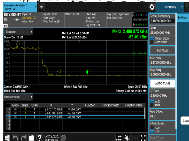
Hopping Band Edge 8DPSK 3M DH5 2480MHz
