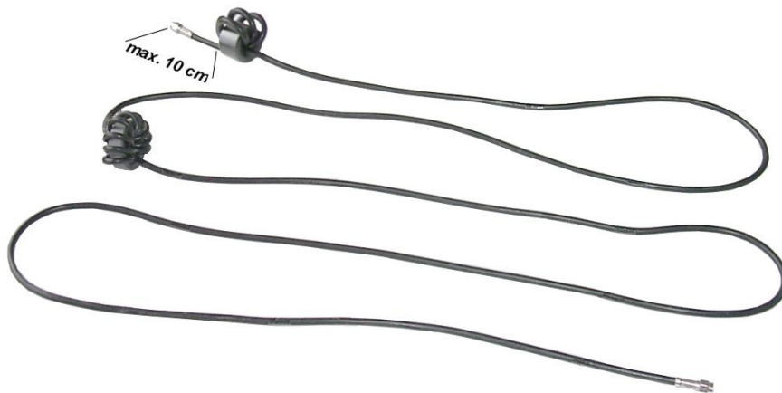
Bild 4: Montage zweier Ringkerne auf Koaxialkabel
