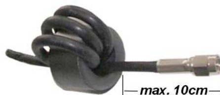
Bild 3-3: Antennenkabel mit EMV-Ringkernferrit
