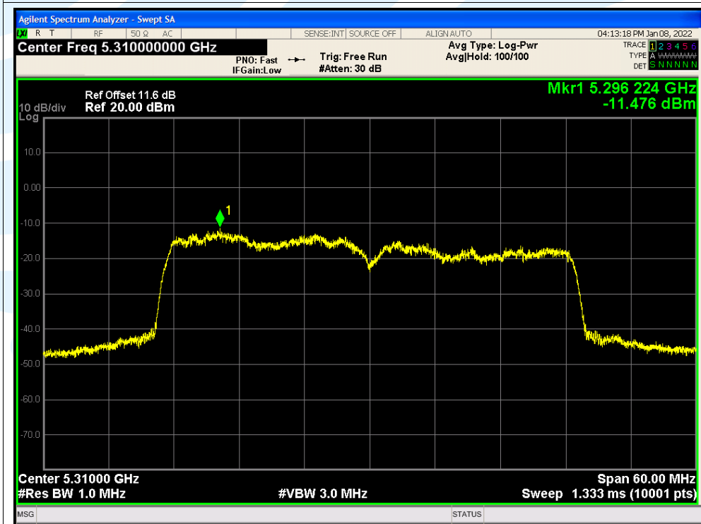
PSD NVNT ac40 5310MHz Ant1
