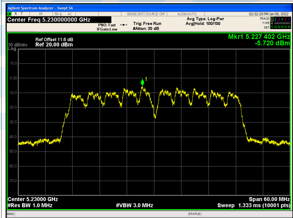
PSD NVNT ax40 5230MHz Ant1
