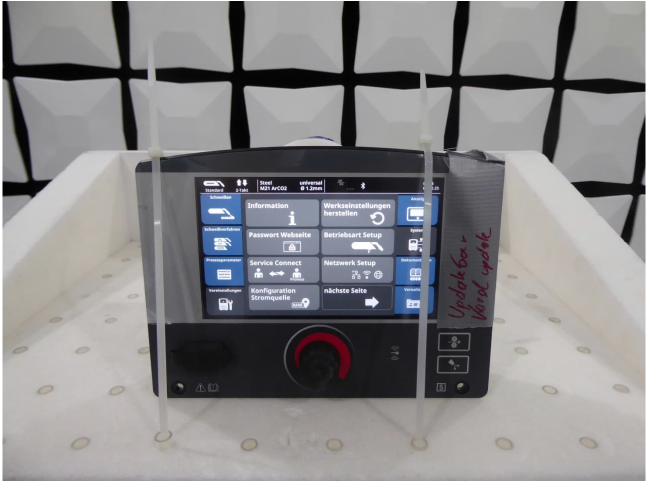
EUT setup – f > 1 \text{ GHz}
