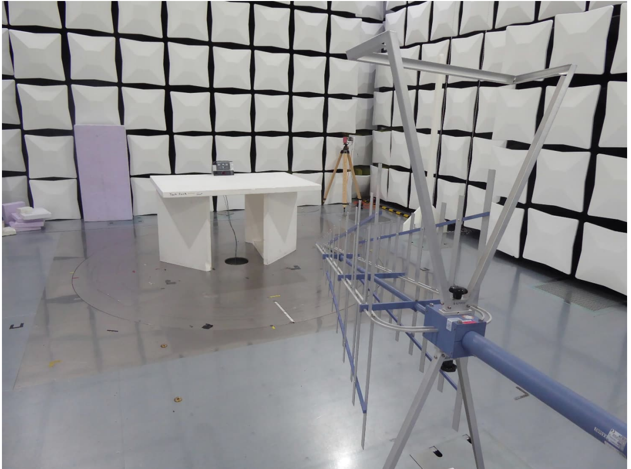
EUT setup – f < 1 \text{ GHz}
