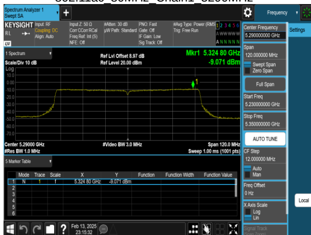
802.11ac 80MHz Chain1 5530MHz
