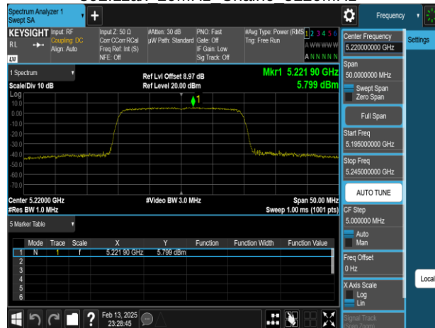
802.11ax 20MHz Chain0 5220MHz
