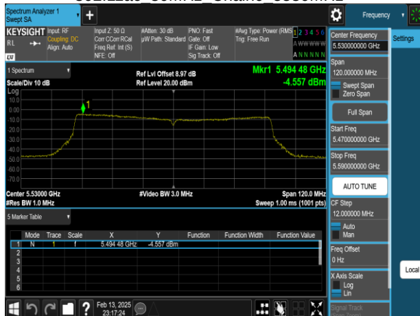
802.11ac 80MHz Chain0 5530MHz
