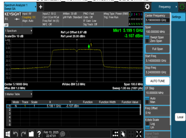
802.11n 40MHz Chain1 5230MHz
