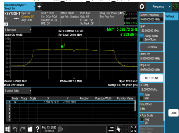
802.11ac 80MHz Chain0 5775MHz
