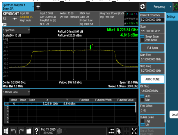
802.11ac 80MHz Chain0 5290MHz
