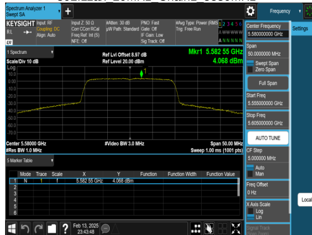
802.11ax 20MHz Chain1 5580MHz
