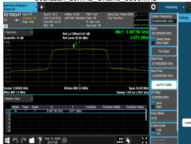
802.11ax 20MHz Chain0 5580MHz
