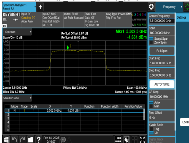
802.11ax 40MHz Chain0 5510MHz
