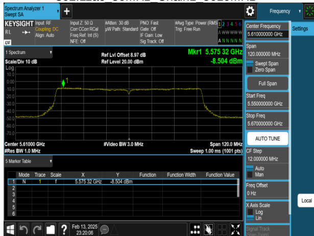
802.11ac 80MHz Chain1 5610MHz
