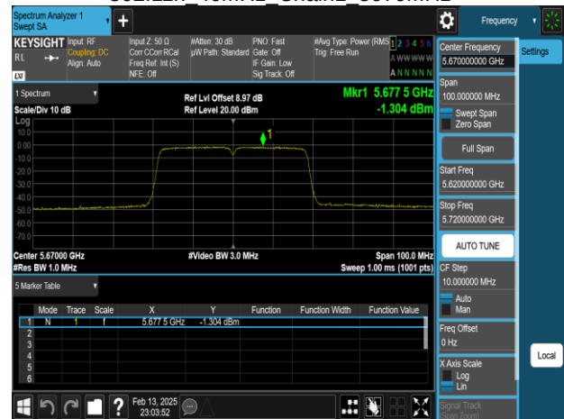
802.11n 40MHz Chain1 5755MHz
