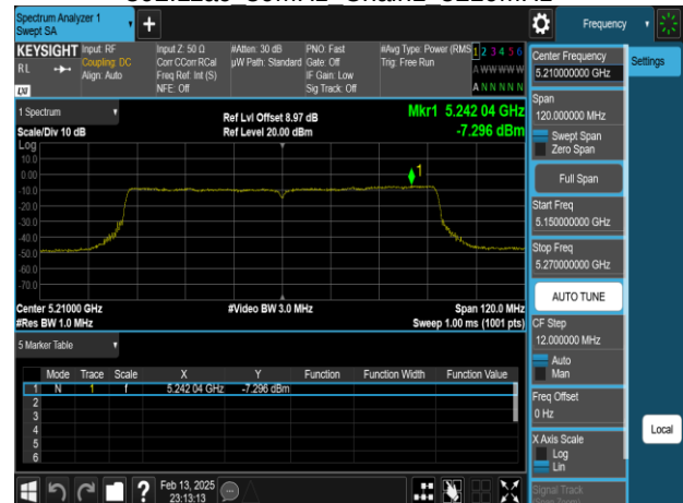
802.11ac 80MHz Chain1 5210MHz
