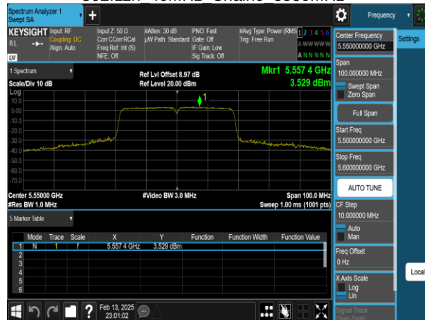
802.11n 40MHz Chain0 5550MHz
