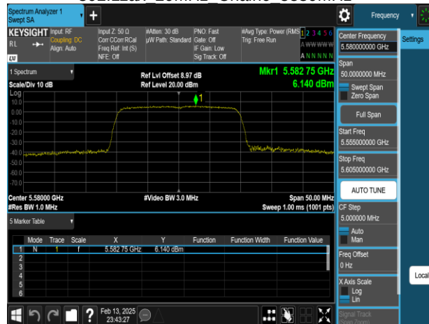
802.11ax 20MHz Chain0 5580MHz
