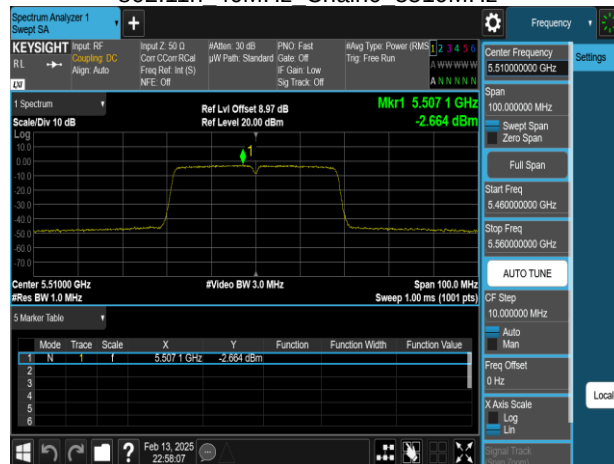
802.11n 40MHz Chain0 5550MHz
