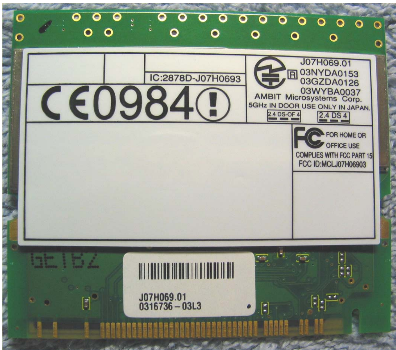
IEEE802.11 mini PCI module, Rear
