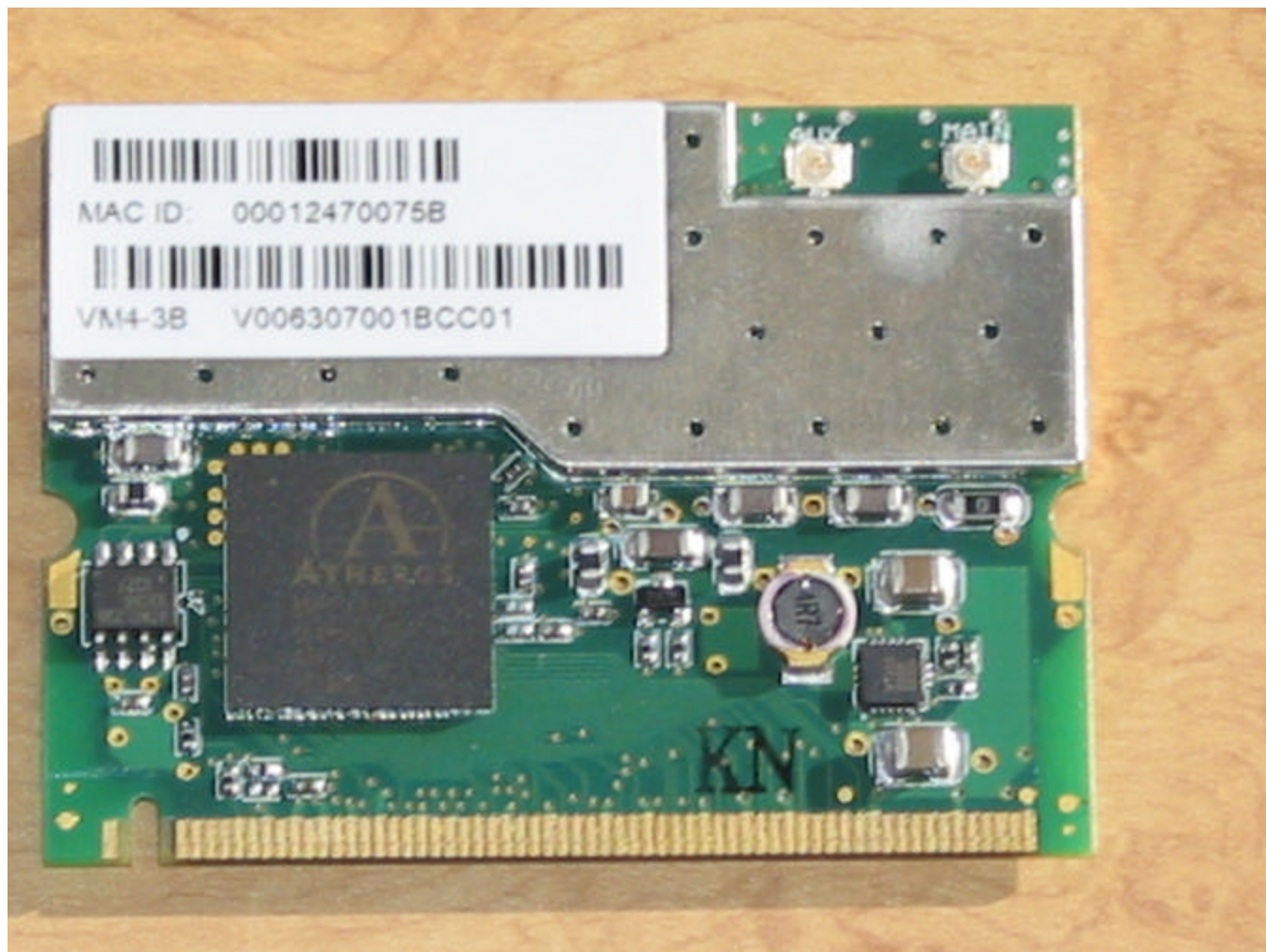
IEEE802.11 mini PCI module, covering removed
