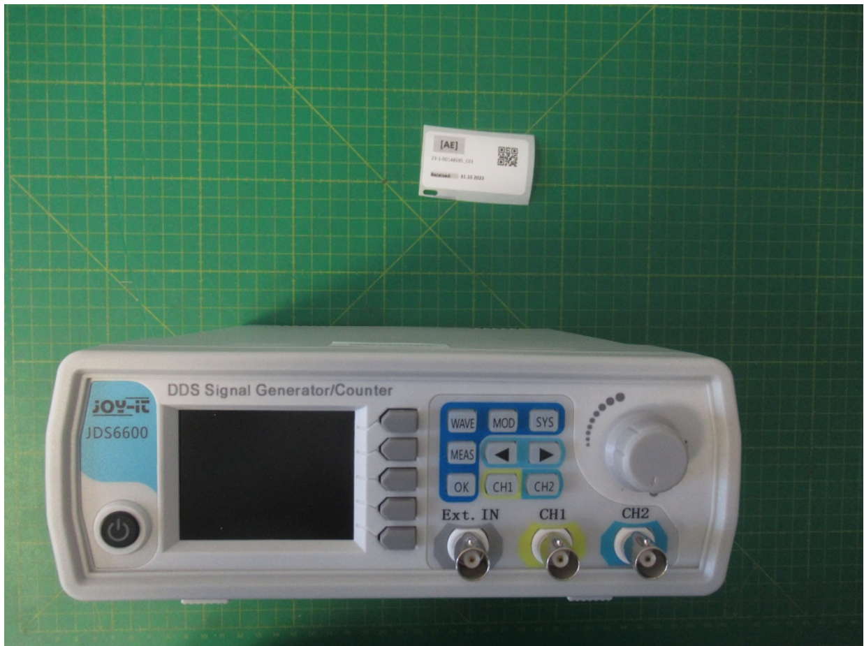
Fig. Ext.: 10 : Ext. - Front DDS Signal generator
