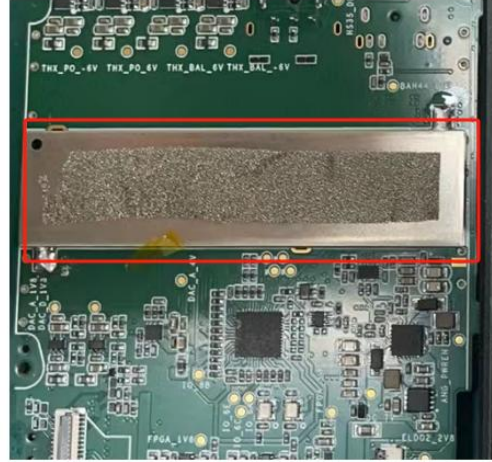
如图:主板屏蔽罩用导电泡棉粘贴与背屏做接地处理
