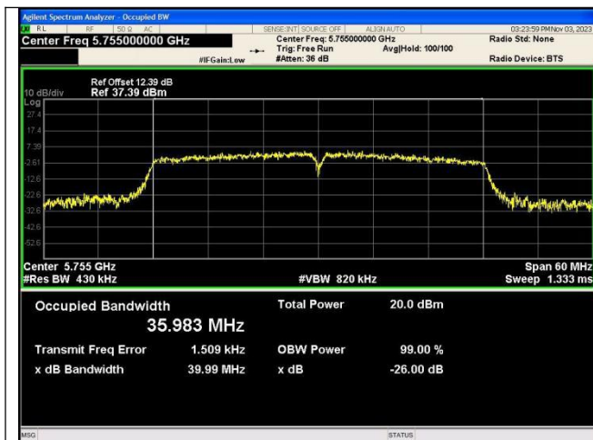
IEEE 802.11n_Channel 151_40MHz_Antenna 0
