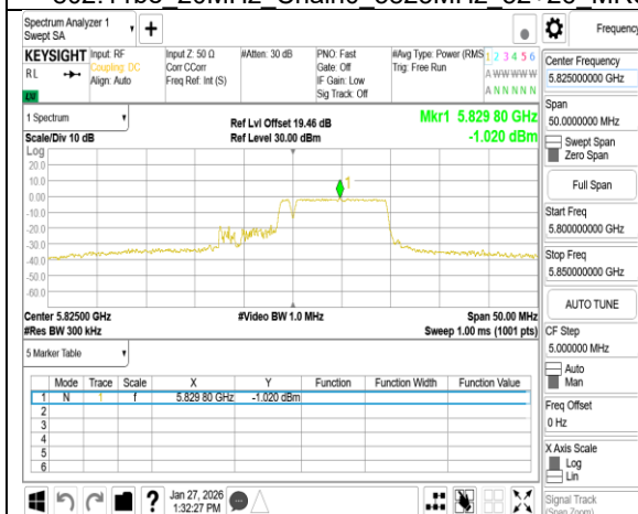
802.11be 20MHz Chain0 5825MHz 106+26 MRU2
