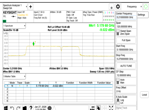
802.11be 80MHz Chain1 5210MHz 484+242 MRU4
