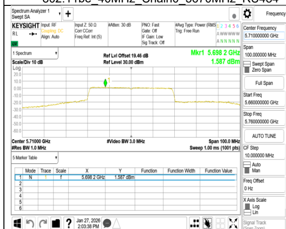
802.11be 40MHz Chain0 5710MHz RU484 UNII 2C
