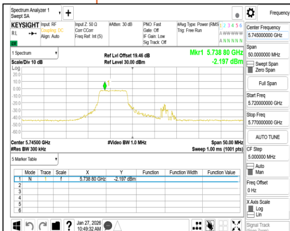
802.11be 20MHz Chain0 5745MHz 52+26 MRU1
