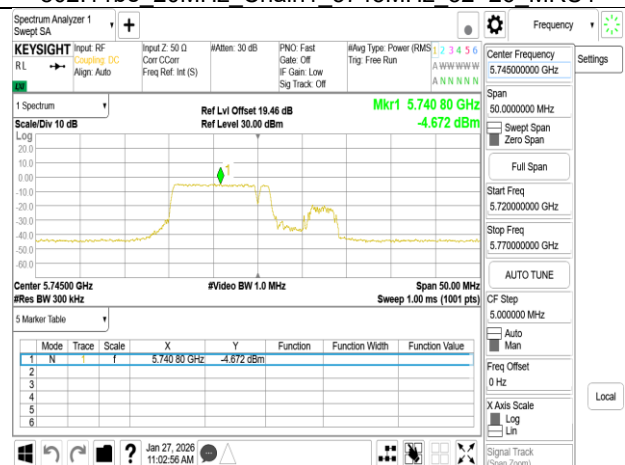
802.11be 20MHz Chain1 5745MHz 106+26 MRU1
