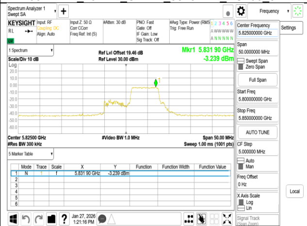
802.11be 20MHz Chain1 5825MHz 52+26 MRU3
