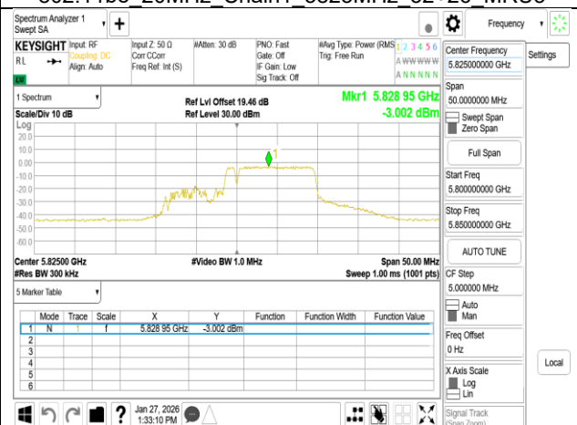
802.11be 20MHz Chain1 5825MHz 106+26 MRU2
