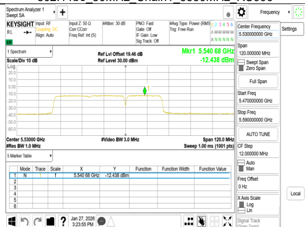
802.11be 80MHz Chain1 5530MHz 484+242 MRU4
