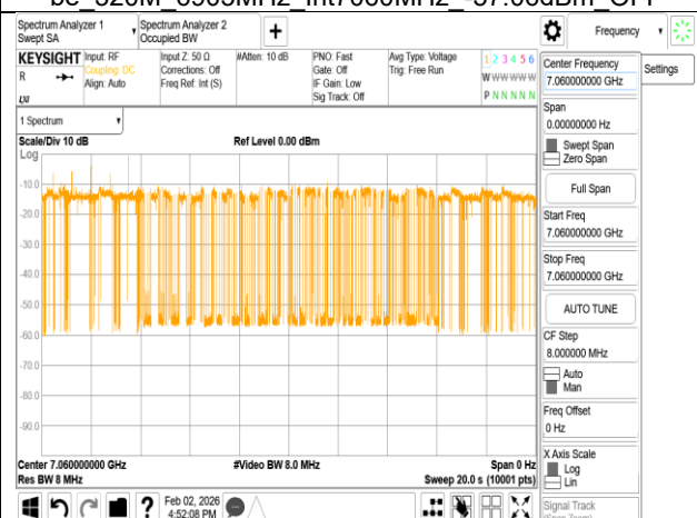
be 320M 6905MHz Int7060MHz -60.06dBm ON
