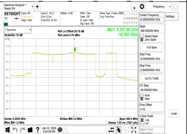
802.11be 320MHz Chain0 6265MHz 3x996+484 MRU7
