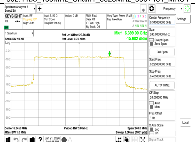
802.11be 160MHz Chain1 6345MHz RU996x2
