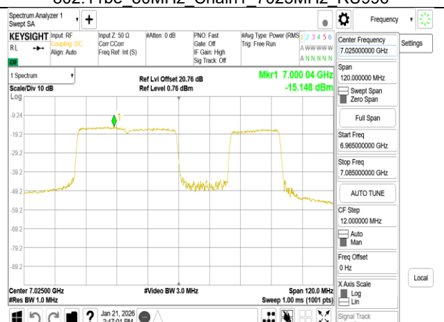
802.11be 80MHz Chain1 7025MHz 484+242 MRU3
