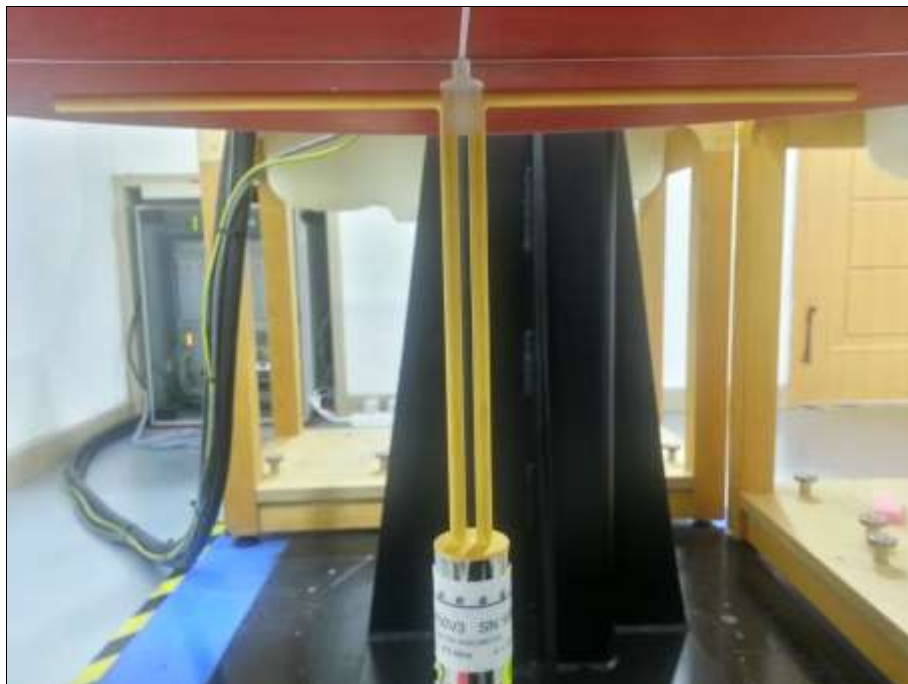
(d) System Check 450 MHz
