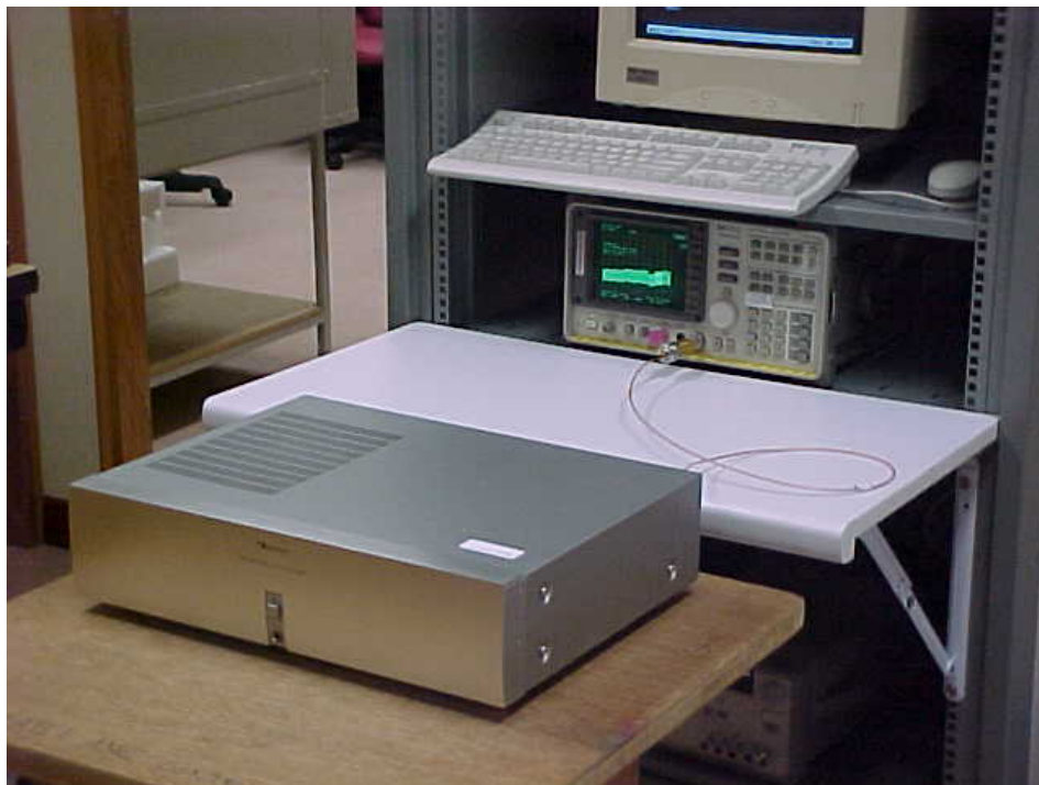
Spectrum Bandwidth Measurement Test Setup – AV Unit
