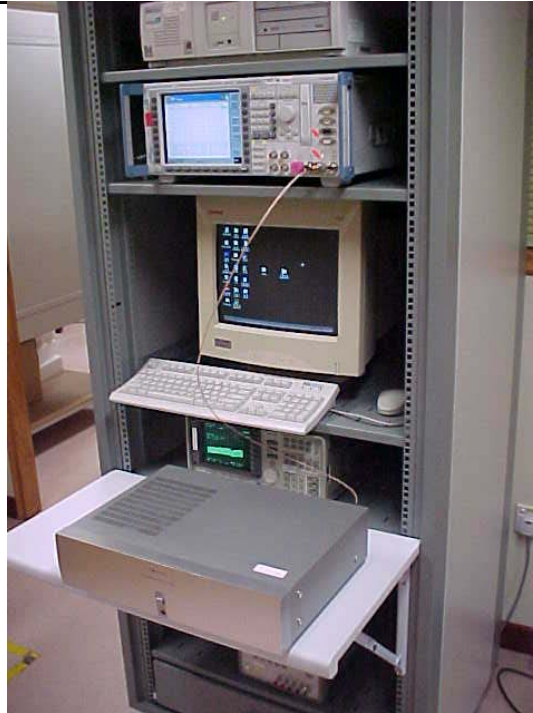
Maximum Peak Power Measurement Test Setup – AV Unit
