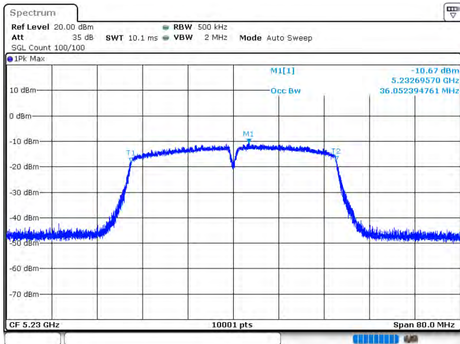
-26 dB BW NVNT 802.11ac40 5230MHz Ant 1
