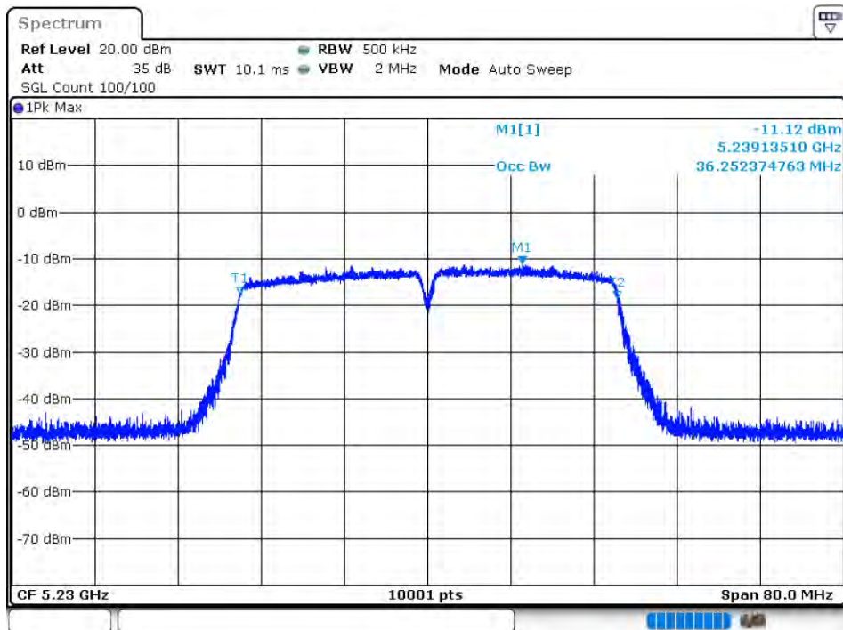
-26 dB BW NVNT 802.11ac40 5230MHz Ant 2
