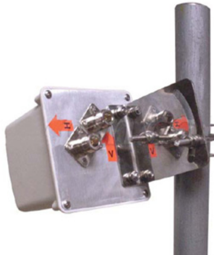
Figure 24. Installing Mini Panel Antenna to the Pole
