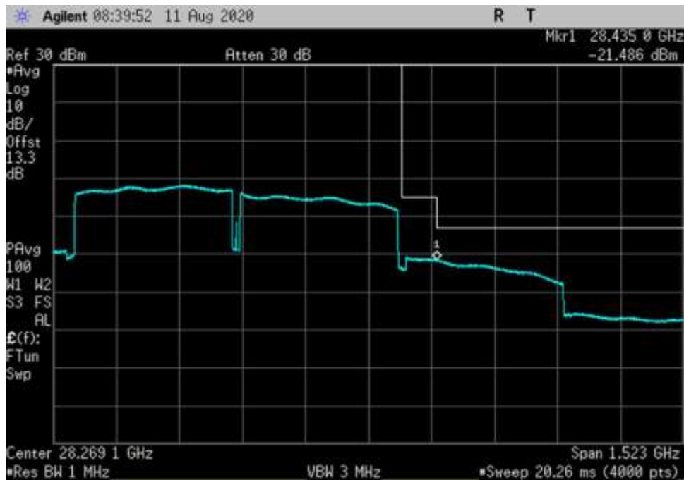
DL_27500-28350- 64QAM-400MHz-V-CP OFDM_HC
