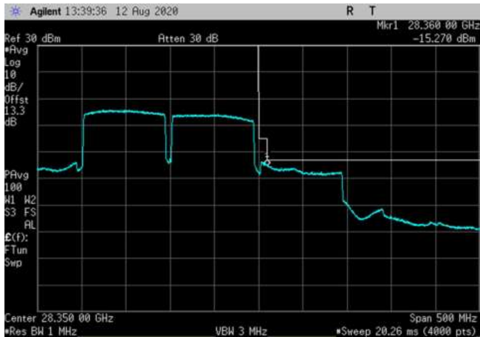
UL_27500-28350-Pi/2- BPSK-100MHz-V-AGC+3-DFT OFDM_HC
