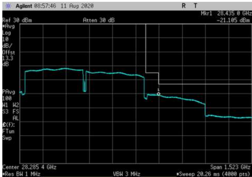
DL_27500-28350- 256QAM-400MHz-V-CP OFDM_HC
