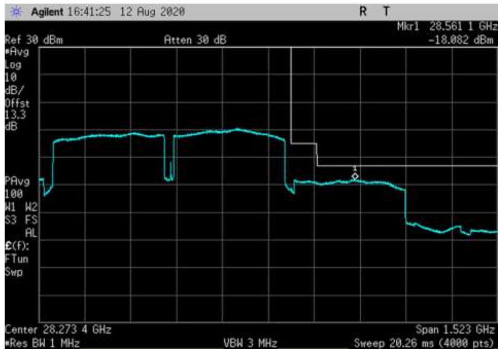
UL_27500-28350-Pi/2- BPSK-400MHz-V-AGC+3-DFT OFDM_HC
