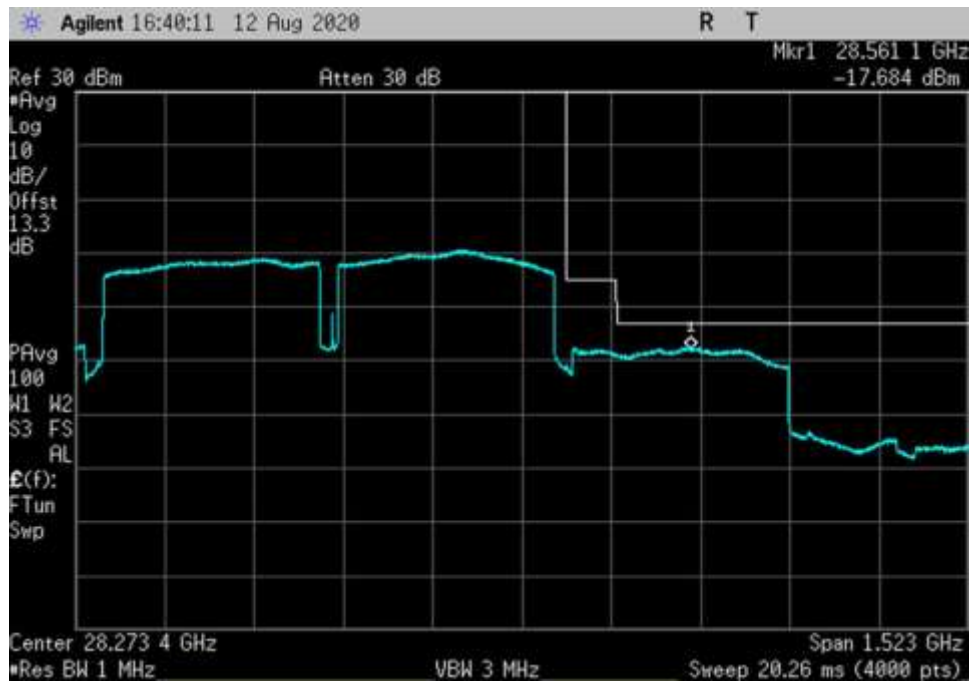
UL_27500-28350-Pi/2- BPSK-400MHz-V-DFT OFDM_HC
