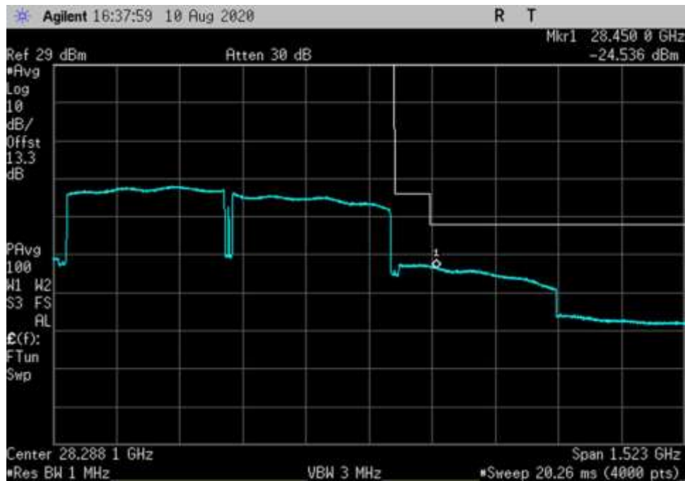
DL_27500-28350- QPSK-400MHz-V-AGC+3-CP OFDM_HC
