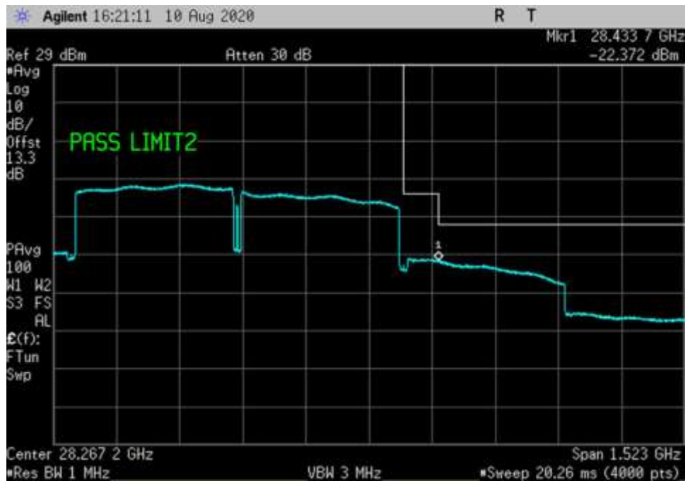
DL_27500-28350- 16QAM-400MHz-V-CP OFDM_HC
