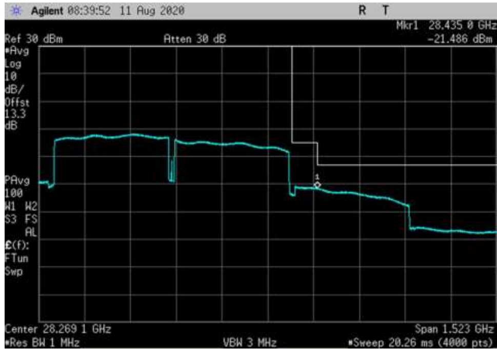
DL_27500-28350- 64QAM-400MHz-V-CP OFDM_HC
