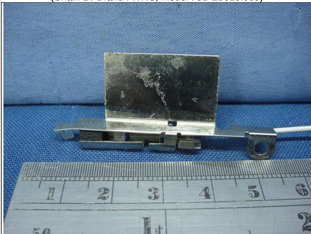
Antenna set 1 (Chain 1 / Brand : WNC, Model : 81-EBJ15.005)
