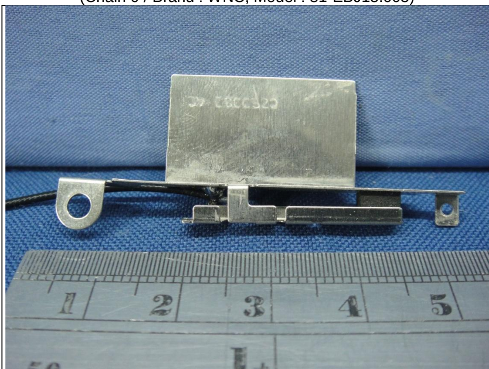
Antenna set 1 (Chain 0 / Brand : WNC, Model : 81-EBJ15.005)
