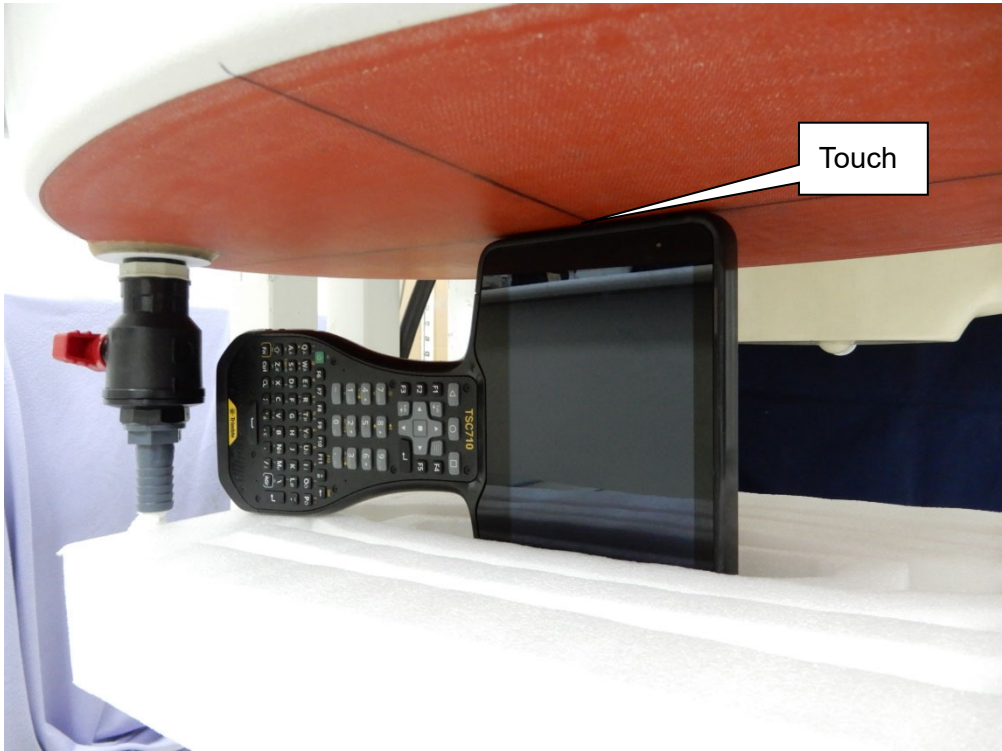
EUT Left-side -10mm (Aux Antenna)
