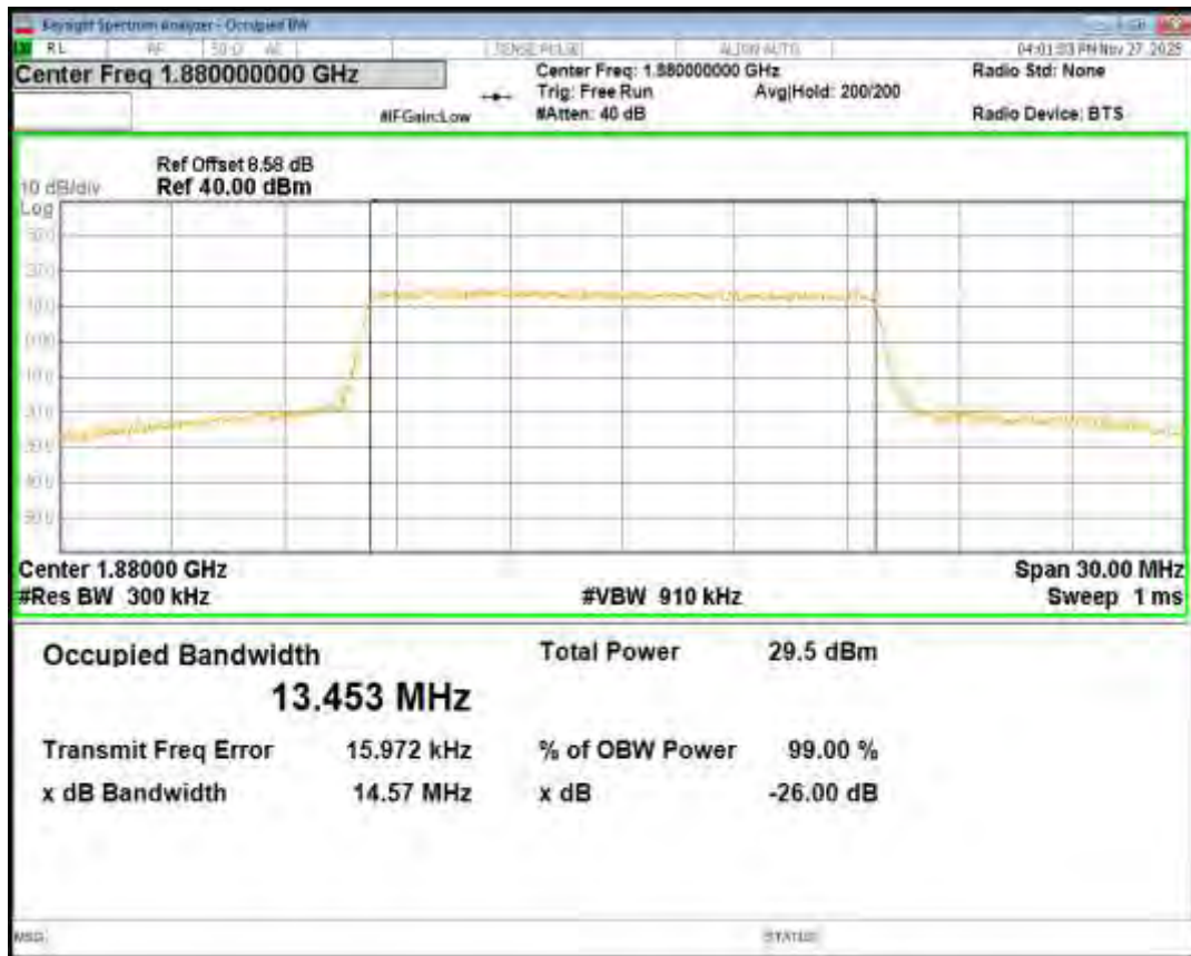
Band2 QPSK BW=20MHz Channel=19100 RB Size=100 Position=#0
