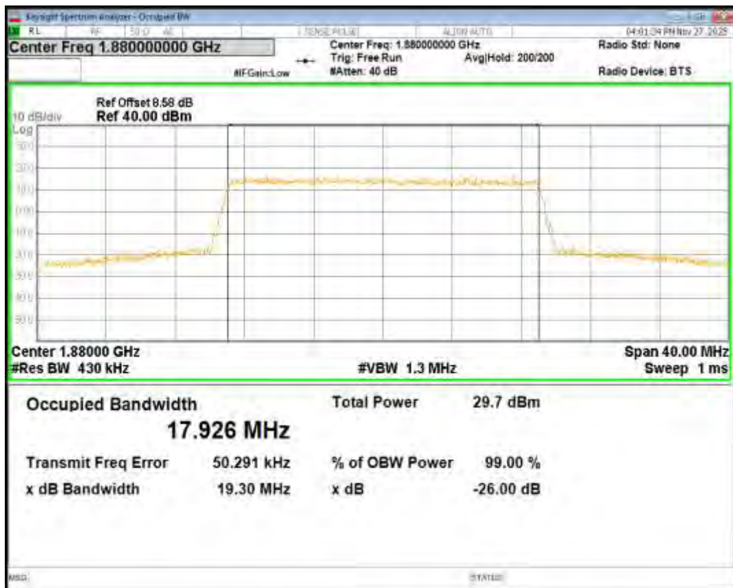
Band2 QPSK BW=20MHz Channel=18700 RB Size=100 Position=#0
