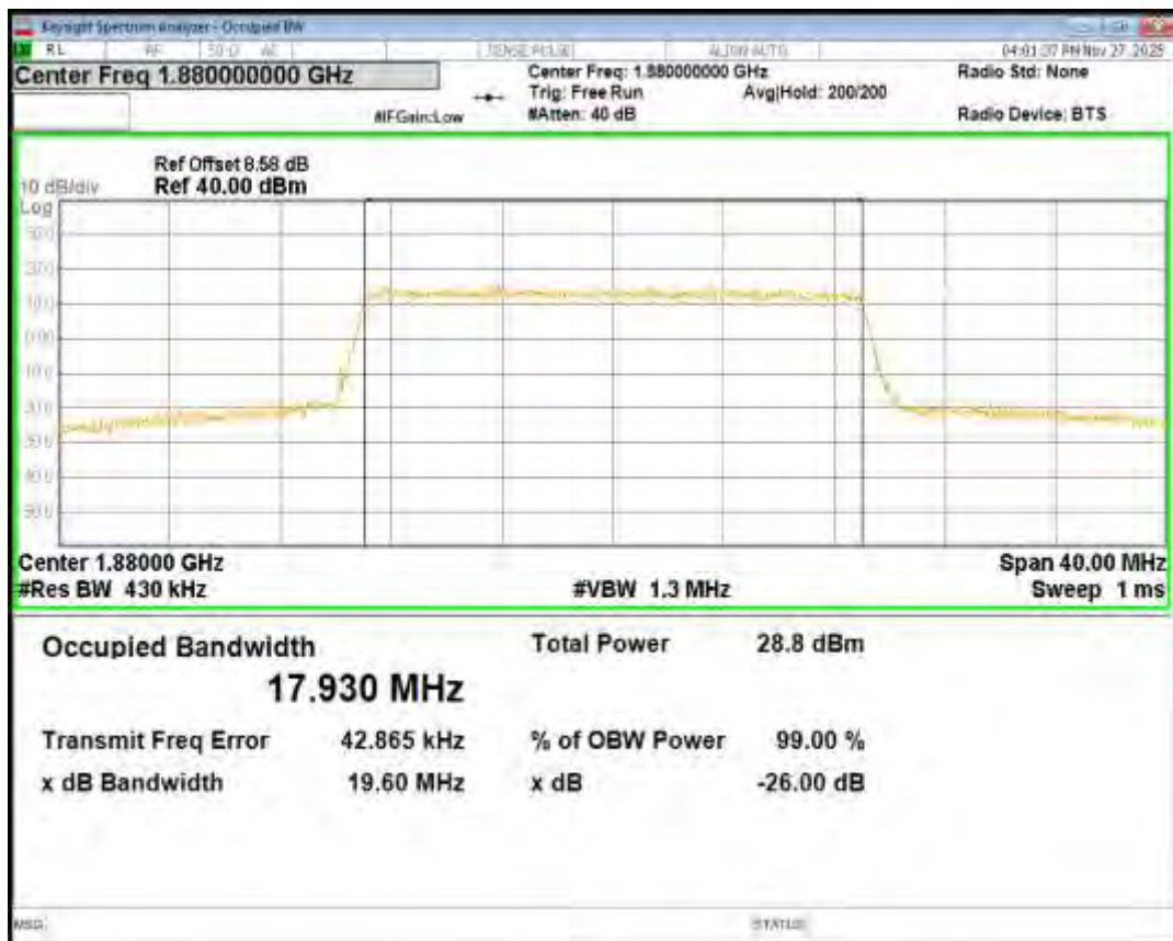
Band2 16QAM BW=20MHz Channel=18700 RB Size=100 Position=#0
