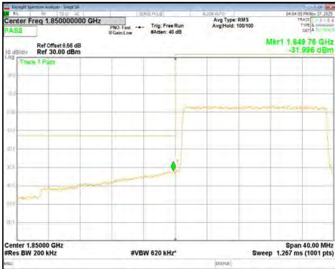
Band2 QPSK BW=20MHz Channel=19100 RB Size=100 Position=#0
