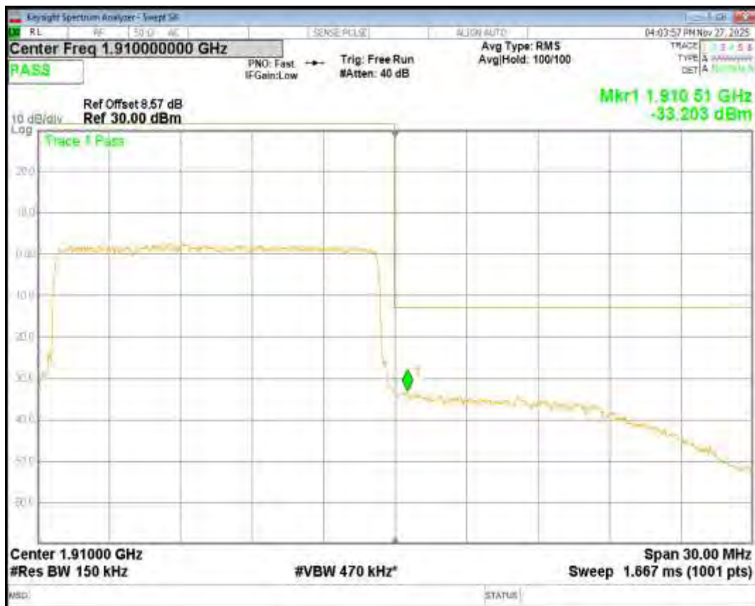
Band2 16QAM BW=20MHz Channel=18700 RB Size=100 Position=#0
