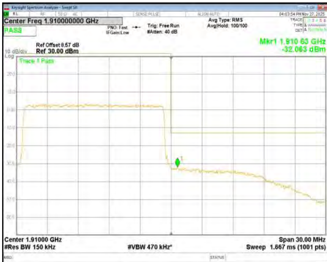
Band2 QPSK BW=20MHz Channel=18700 RB Size=100 Position=#0
