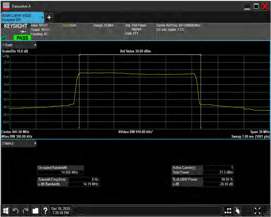
n5 SCS=15kHz DFT QPSK BW=20MHz Channel=166800 RB=100@0
