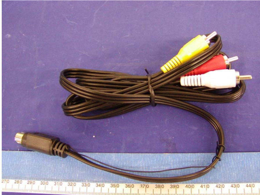
AV Cable I
