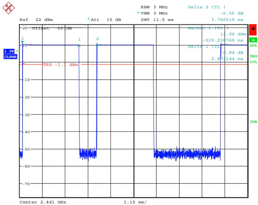
170279\_DutyCycle2\_BT\_DH5\_BT39.wmf: Duty cycle measurement on channel 39 in DH5-mode
