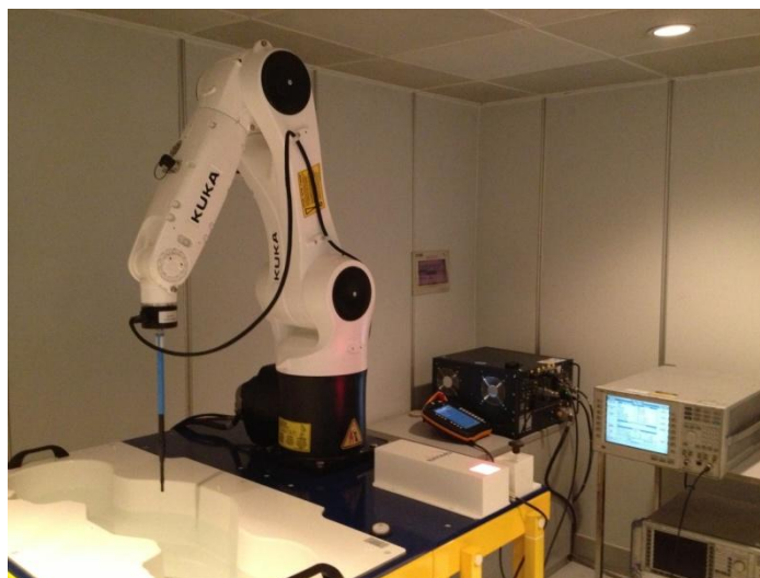
Fig.1 COMO SAR Test System
