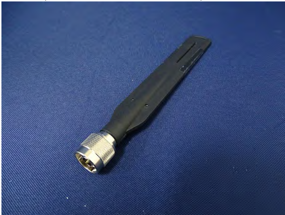
(26) EUT Photo (Antenna 7_ MOXA / ANT-WDB-ANM-0502)
