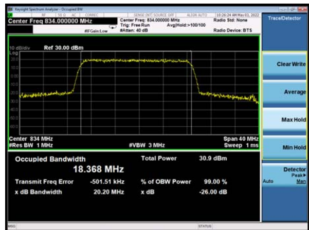
DC_66A-n5A QPSK 20MHz CH-Middle
