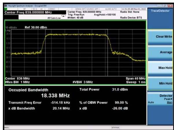
DC_66A-n5A QPSK 20MHz CH-High
