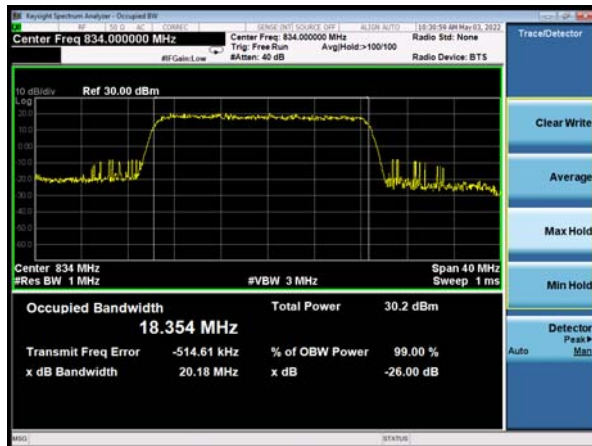
DC_66A-n5A 16QAM 20MHz CH-Middle
