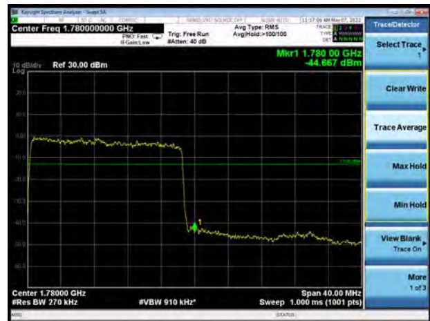
DC_5A-n66A QPSK 20MHzCH-High 1RB
