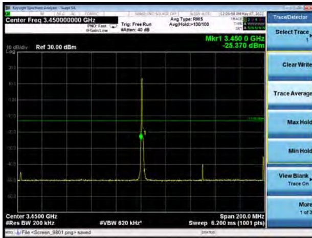
NR n77 subset 1 64QAM 100MHz CH-Low 100%RB
