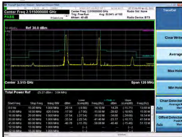
CA_7C QPSK 20MHz+10MHz CH-Low, 100%RB
