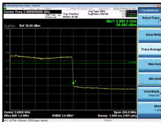
DC_2A-n77(subset 2)A256QAM 100MHz CH-High 1RB
