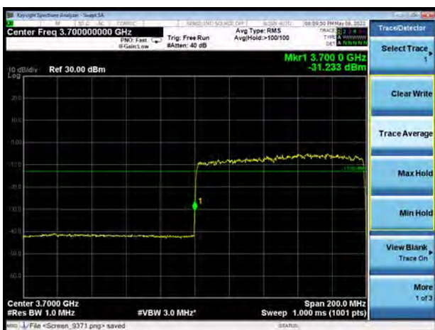
DC_2A-n77(subset 2)A256QAM 100MHz CH-Low 1RB
