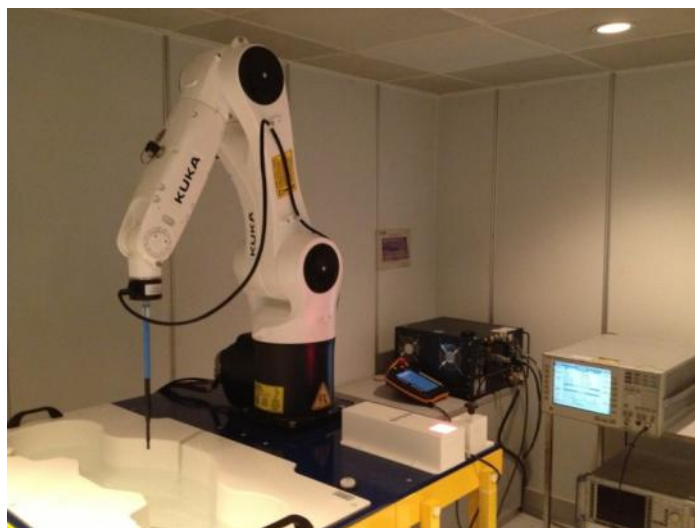
Fig.1 COMO SAR Test System
