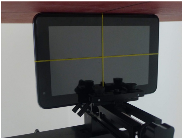
Edge 2 with Phantom 0 cm Gap
