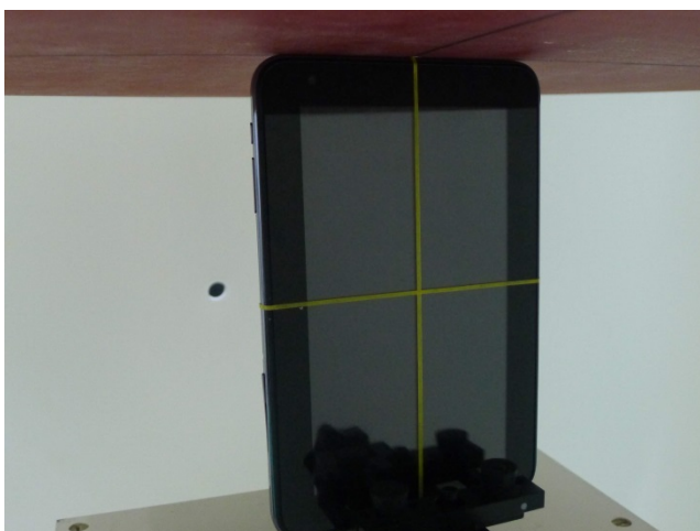
Edge 1 with Phantom 0 cm Gap
