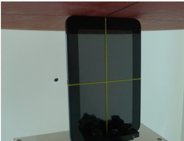
Edge 3 with Phantom 0 cm Gap
