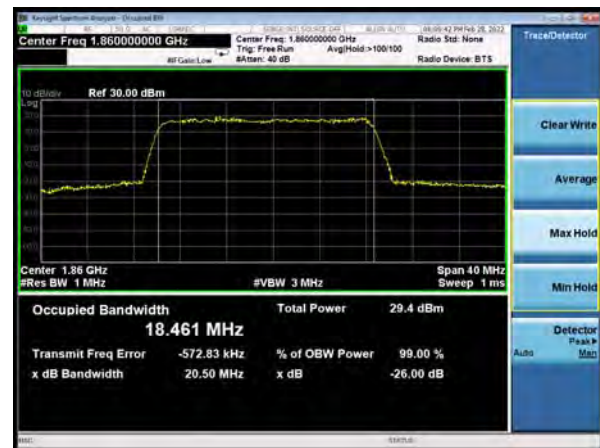
DC_66A_n25A 64QAM 20MHz CH-Middle
