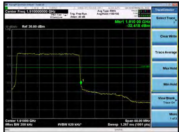
DC_12A_n2A QPSK 20MHz CH-High 1RB
