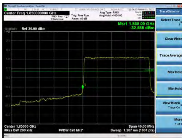
NR n2 QPSK 20MHz CH-Low 1RB
