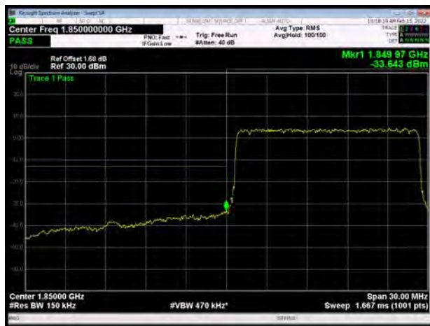
LTE Band 2 20MHz QPSK 1RB CH-Low
