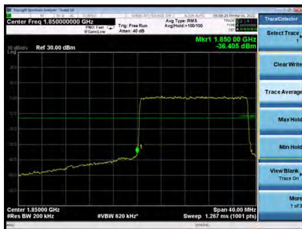
NR n2 256QAM 20MHz CH-Low 1RB
