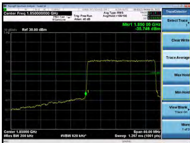
NR n25 16QAM 20MHz CH-Low 100%RB
