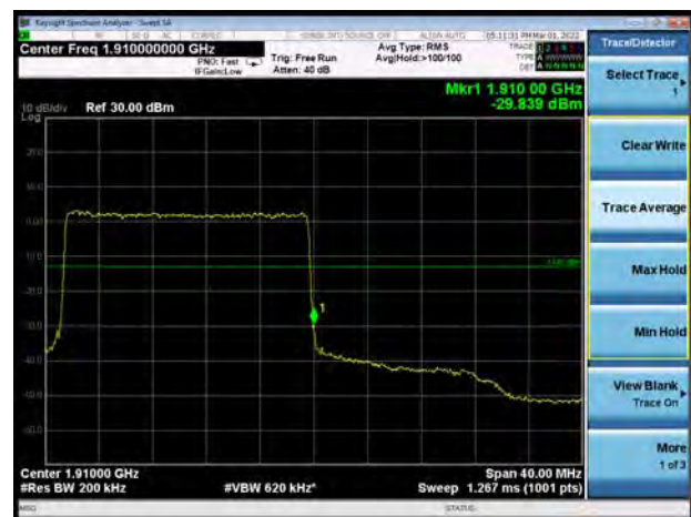
NR n2 QPSK 20MHz CH-High 1RB
