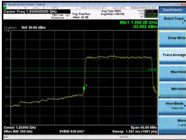
NR n2 16QAM 20MHz CH-Low 1RB
