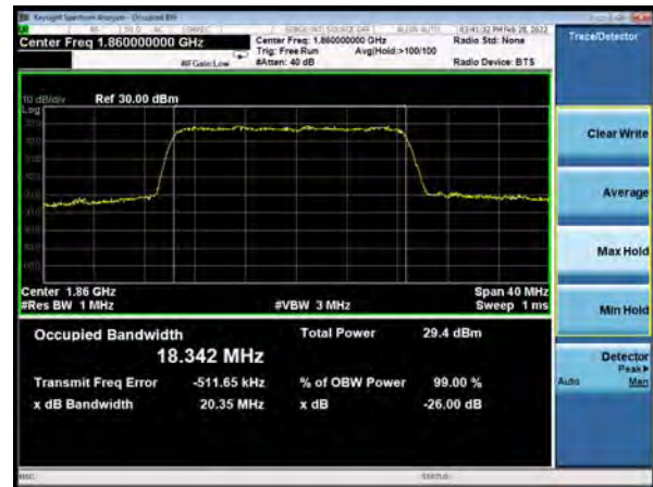
DC_12A_n2A 64QAM 20MHz CH-Middle
