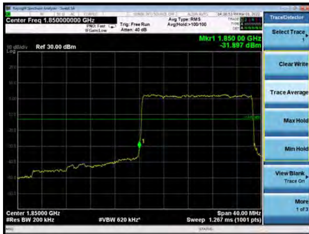
DC_66A_n25A QPSK 20MHz CH-Low 1RB
