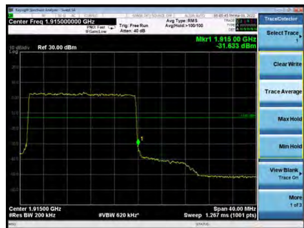
NR n25 QPSK 20MHz CH-High 1RB
