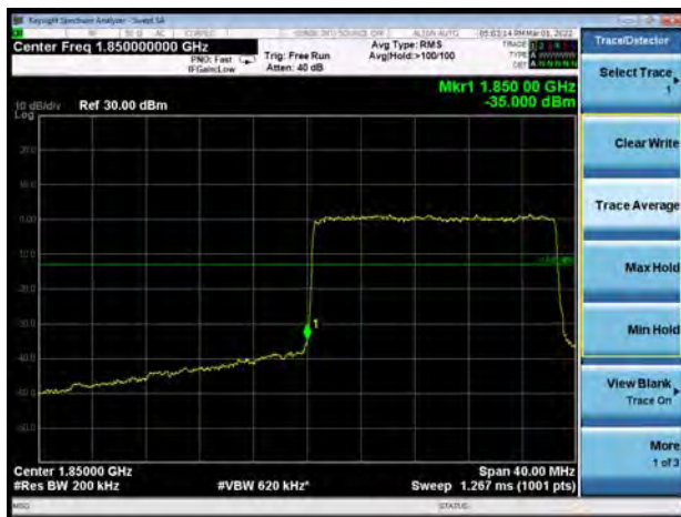
NR n25 256QAM 20MHz CH-Low 1RB
