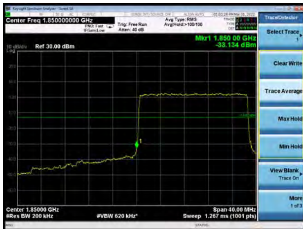
NR n25 16QAM 20MHz CH-Low 1RB
