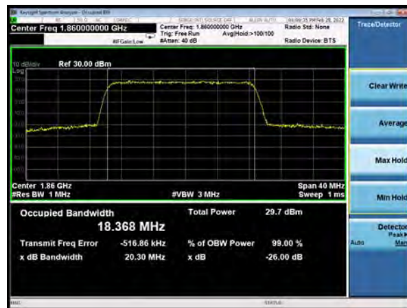
DC_66A_n25A 16QAM 20MHz CH-Middle
