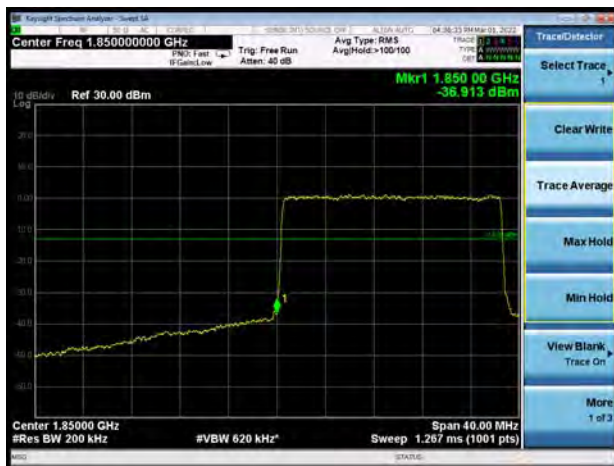
DC_66A_n25A 64QAM 20MHz CH-Low 100%RB
