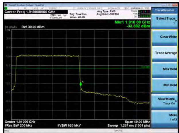
NR n2 16QAM 20MHz CH-High 100%RB
