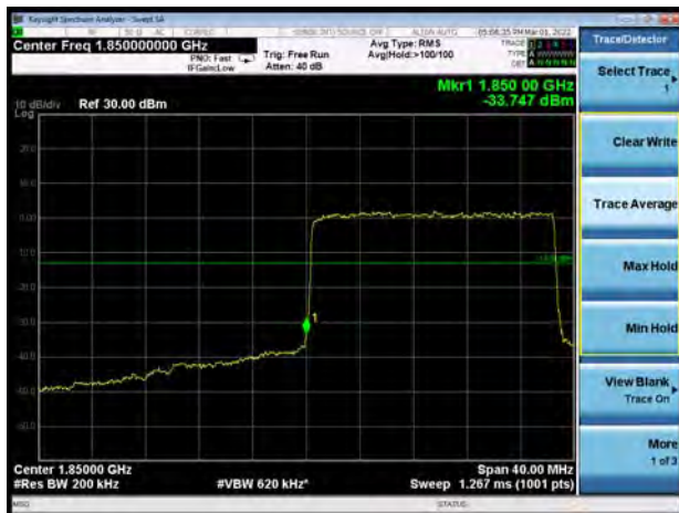
NR n2 16QAM 20MHz CH-Low 100%RB
