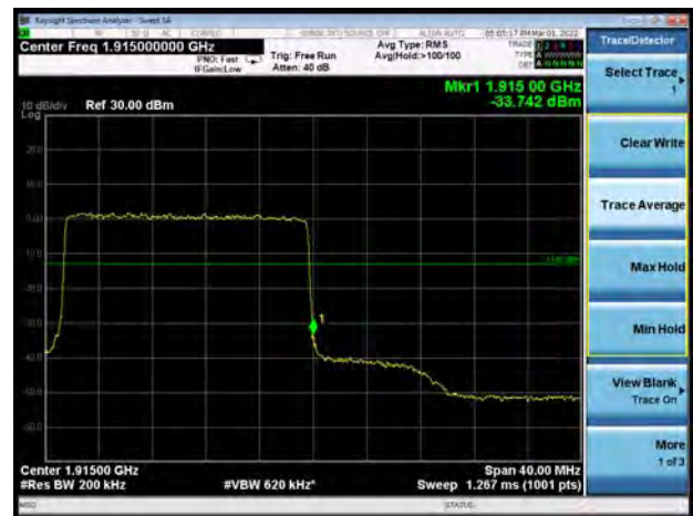
NR n25 256QAM 20MHz CH-High 1RB
