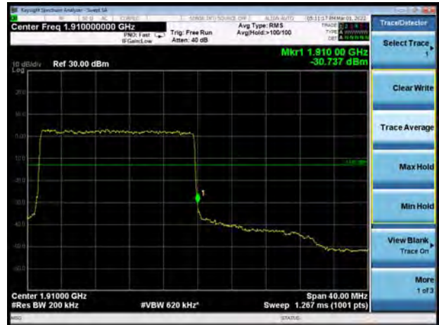
NR n2 16QAM 20MHz CH-High 1RB
