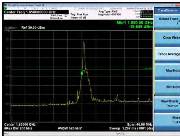
NR n2 64QAM 20MHz CH-Low 100%RB
