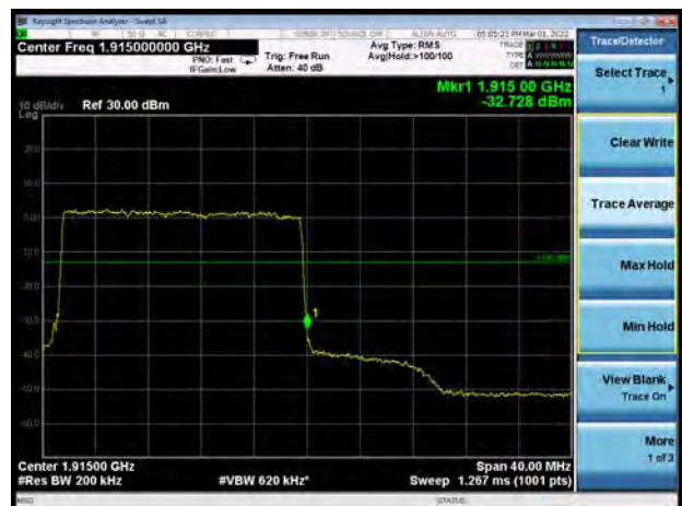
NR n25 16QAM 20MHz CH-High 100%RB
