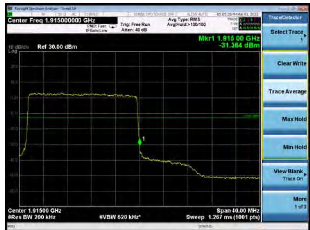
NR n25 16QAM 20MHz CH-High 1RB
