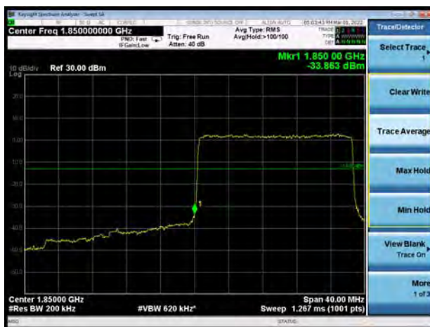
NR n25 QPSK 20MHz CH-Low 1RB
