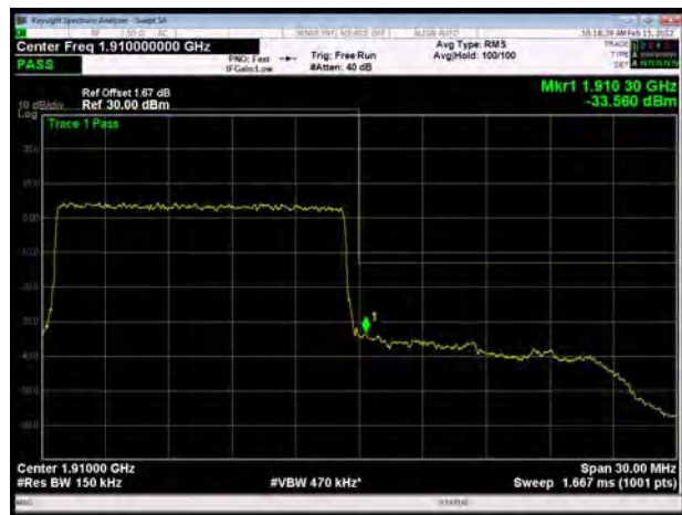
LTE Band 2 20MHz QPSK 1RB CH-High
