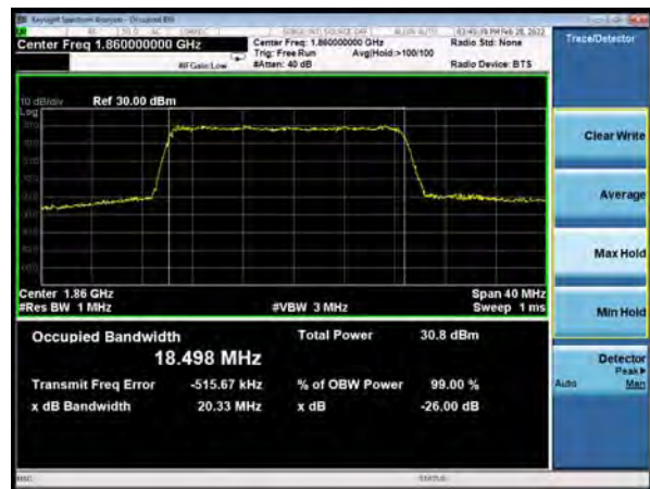
DC_12A_n2A QPSK 20MHz CH-Middle
