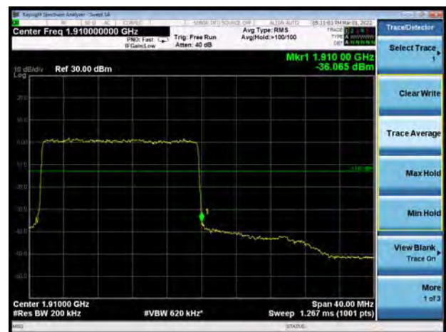
NR n2 256QAM 20MHz CH-High 1RB
