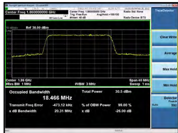
DC_66A_n25A QPSK 20MHz CH-Middle
