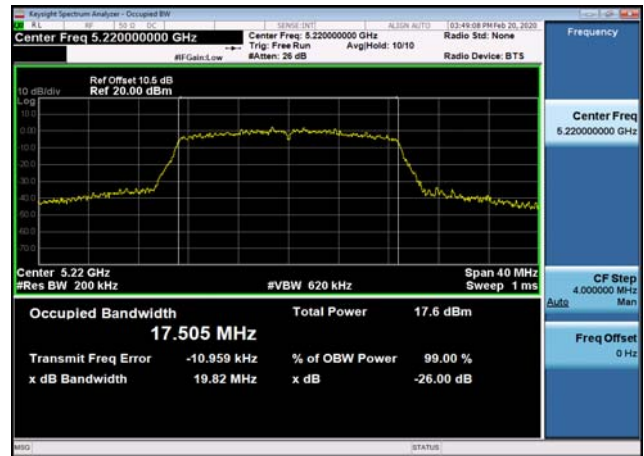
U-NII-1 26dB Bandwidth-802.11ac(40MHz) ,5190MHz
