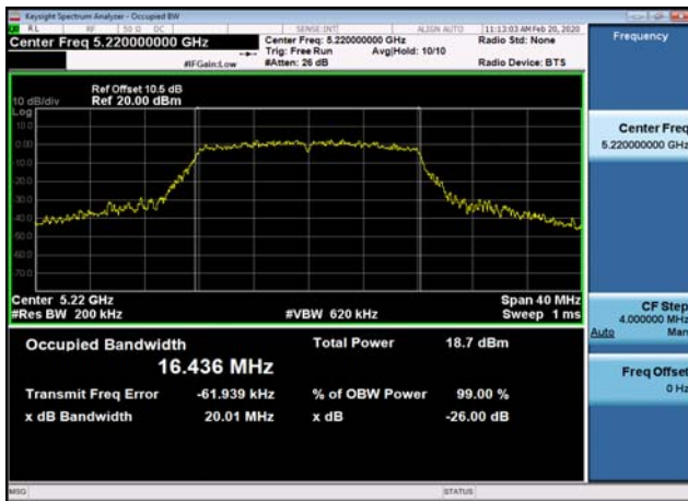
U-NII-1 26dB Bandwidth-802.11ac(20MHz) ,5180MHz
