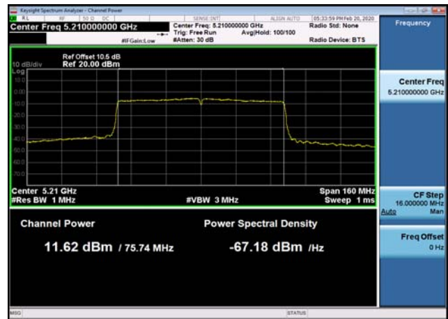
U-NII-3 Output Power-802.11n(20MHz) ,5785MHz
