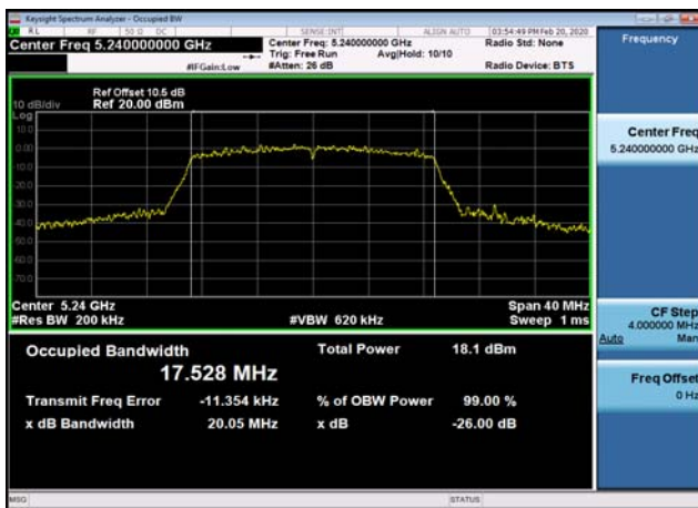
U-NII-1 26dB Bandwidth-802.11ac(20MHz) ,5240MHz
