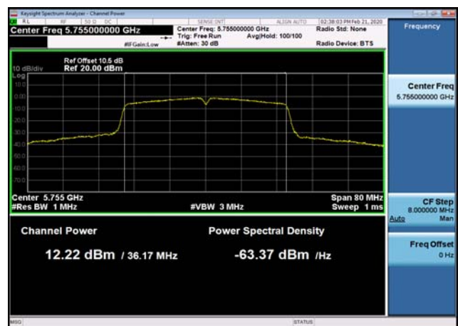
U-NII-3 Output Power-802.11n(40MHz) ,5755MHz
