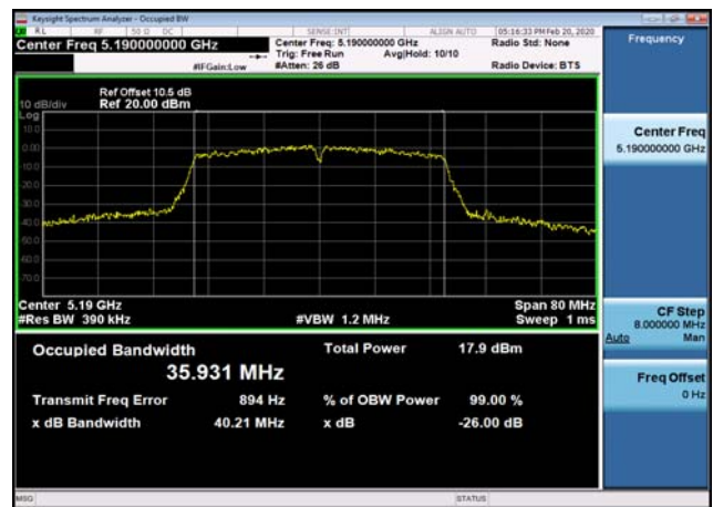
U-NII-1 26dB Bandwidth-802.11ac(40MHz) ,5190MHz
