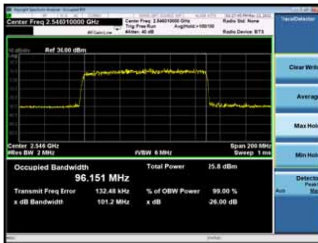
NR n41 256QAM 100%RB 100MHz z CH-Middle
