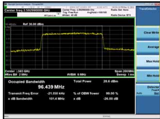
DC_2A_n41A 16QAM 100%RB 100MHz CH-High
