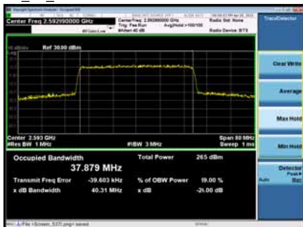
DC_2A_n41A QPSK100 %RB 40MHz CH-Middle
