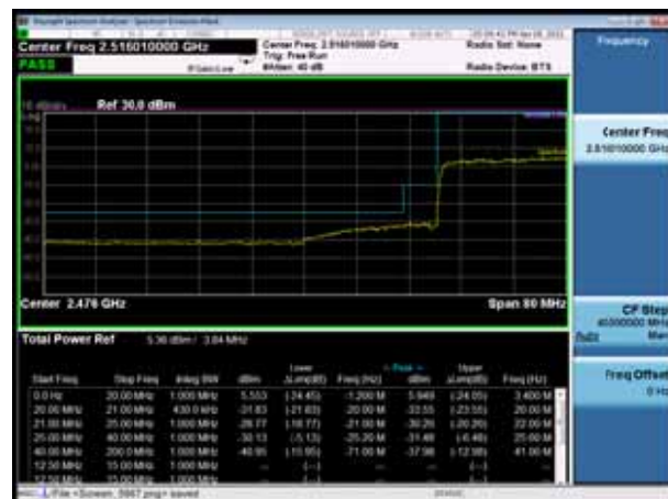
DC_2A_n41A 40MHz QPSK 1RB CH-Low
