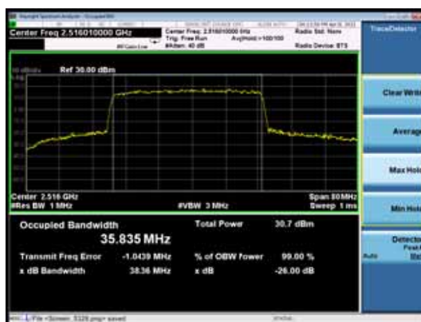
NR n41 64QAM 100%RB40MHz CH-Middle
