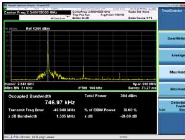
DC_2A_n41A QPSK 1RB 100MHz CH-Middle
