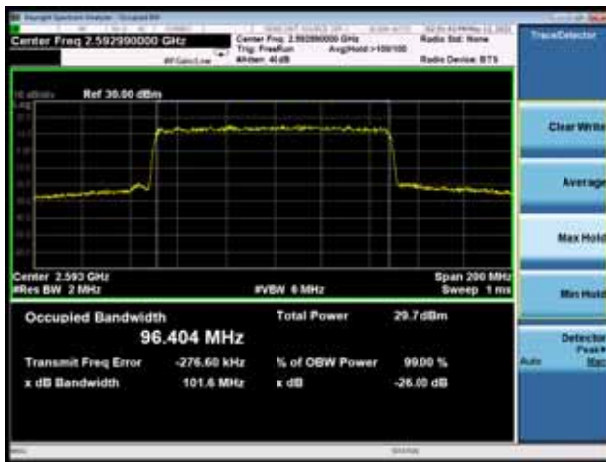
DC_2A_n41A QPSK 100%RB 100MHz CH-High
