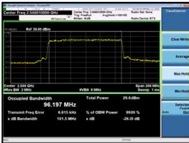
DC_2A_n41A QPSK 100%RB 100MHz CH-Middle
