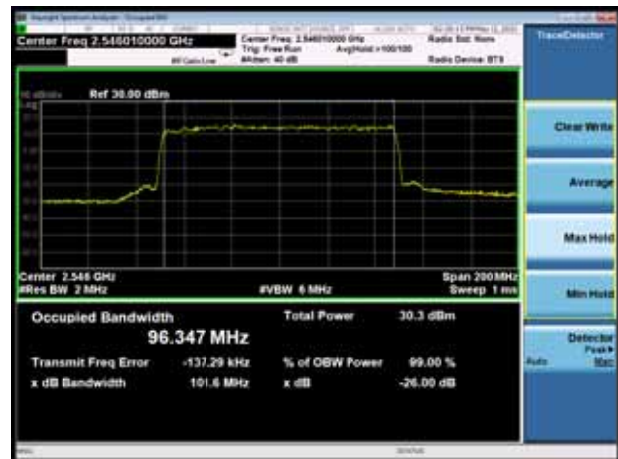
NR n41 QPSK 100%RB 100MHz CH-Middle
