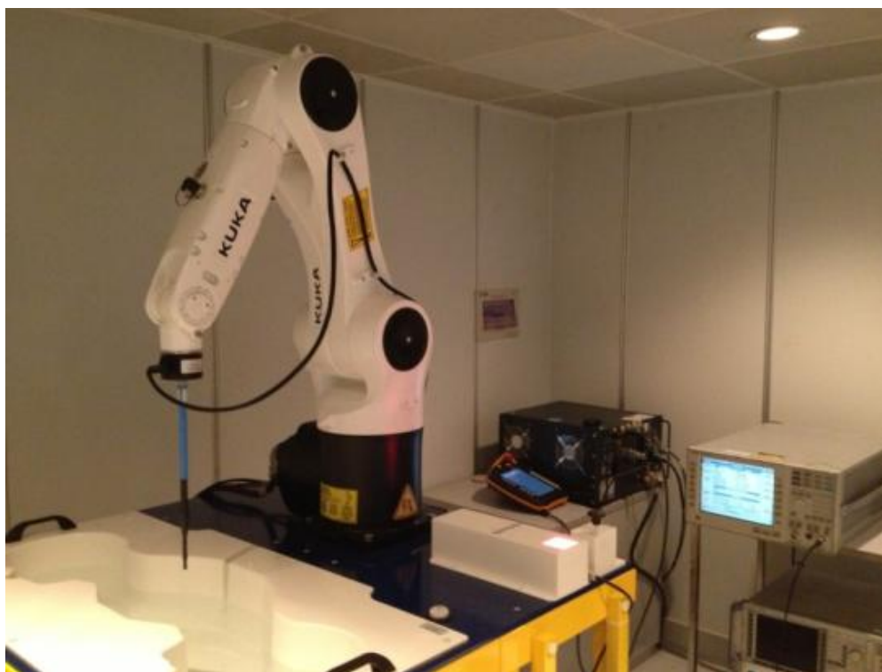
Fig.1 COMO SAR Test System
