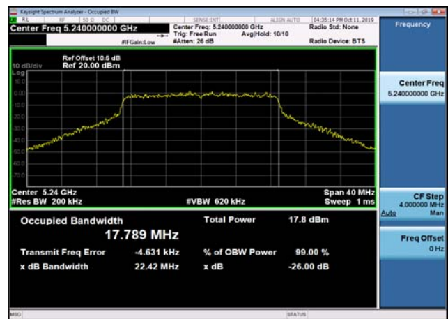
U-NII-1 26dB Bandwidth-802.11ac(40MHz) ,5190MHz,Ant2
