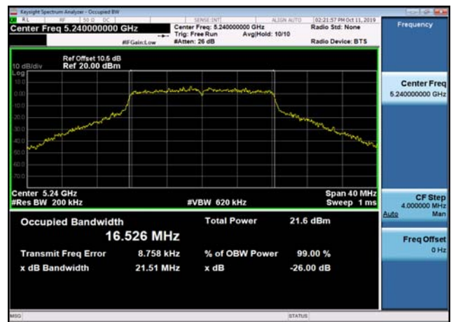
U-NII-1 26dB Bandwidth-802.11ac(20MHz) ,5180MHz,Ant2
