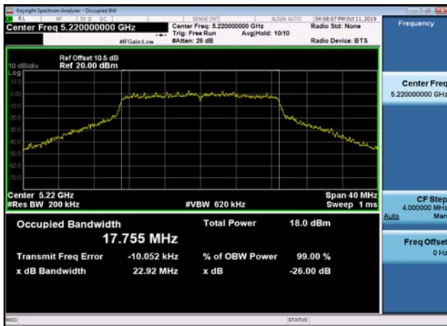
U-NII-1 26dB Bandwidth-802.11ac(20MHz) ,5240MHz,Ant1
