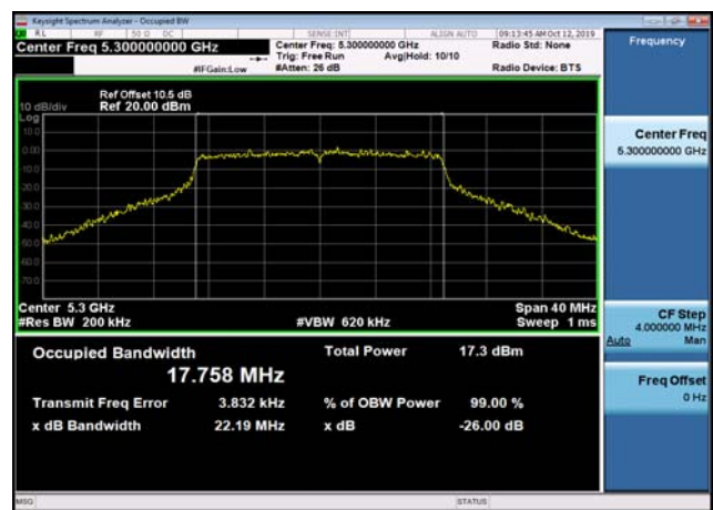
U-NII-2a 26dB Bandwidth-802.11n(20MHz) ,5300MHz,Ant2
