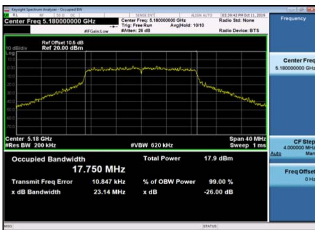
U-NII-1 26dB Bandwidth-802.11ac(20MHz) ,5180MHz,Ant1
