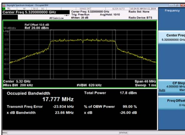
U-NII-2a 26dB Bandwidth-802.11ac(20MHz),5320MHz,Ant1
