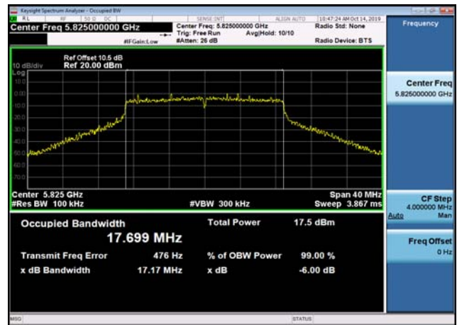
U-NII-3 6dB Bandwidth-802.11ac(40MHz) ,5755MHz,Ant2
