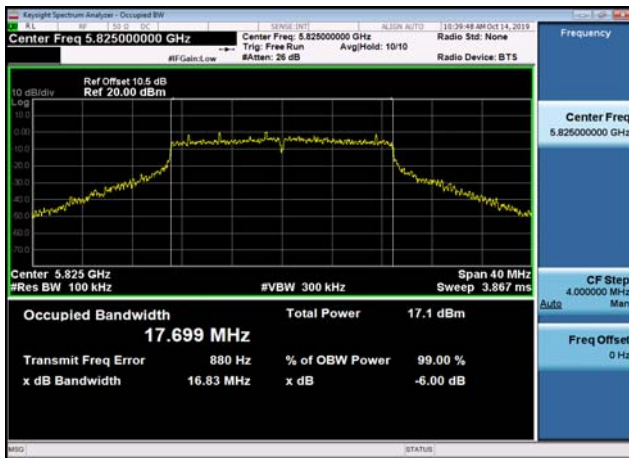
U-NII-3 6dB Bandwidth-802.11ac(40MHz) ,5755MHz,Ant1
