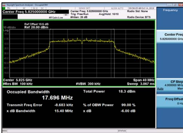
U-NII-3 6dB Bandwidth-802.11n(40MHz) ,5755MHz,Ant1
