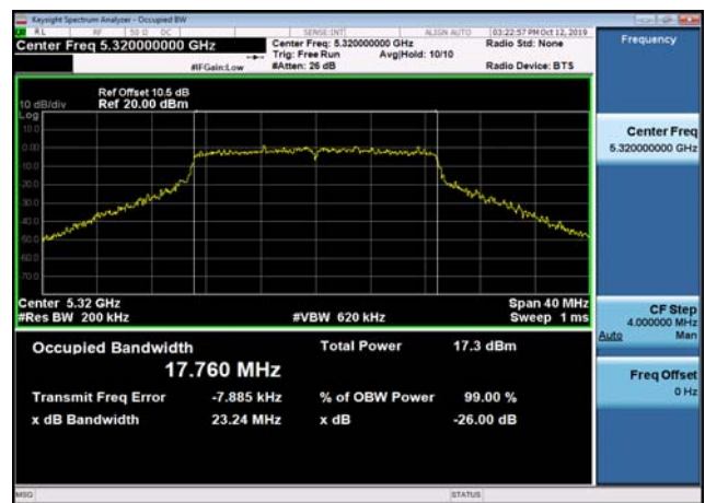
U-NII-2a 26dB Bandwidth-802.11ac(20MHz),5320MHz,Ant2
