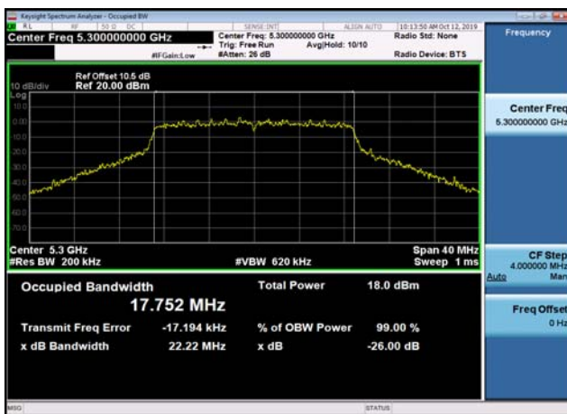
U-NII-2a 26dB Bandwidth-802.11ac(20MHz),5320MHz,Ant1
