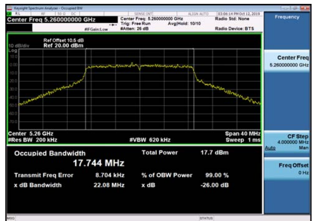
U-NII-2a 26dB Bandwidth-802.11ac(20MHz),5300MHz,Ant2
