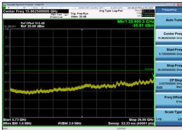
U-NII-2c ,Plot 3,5725MHz~26000MHz-802 .11ac(20MHz),5600MHz,Ant1
