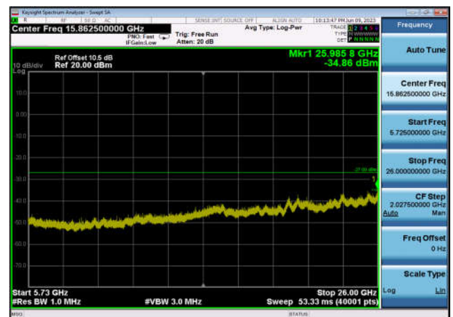
U-NII-2c ,Plot 3,5725MHz~26000MHz-802 .11ac(40MHz),5590MHz,Ant1
