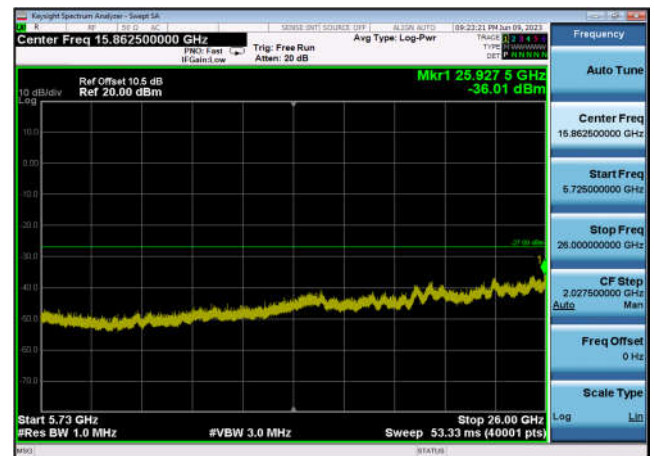
U-NII-2c ,Plot 3,5725MHz~26000MHz-802 .11ac(20MHz),5700MHz,Ant1
