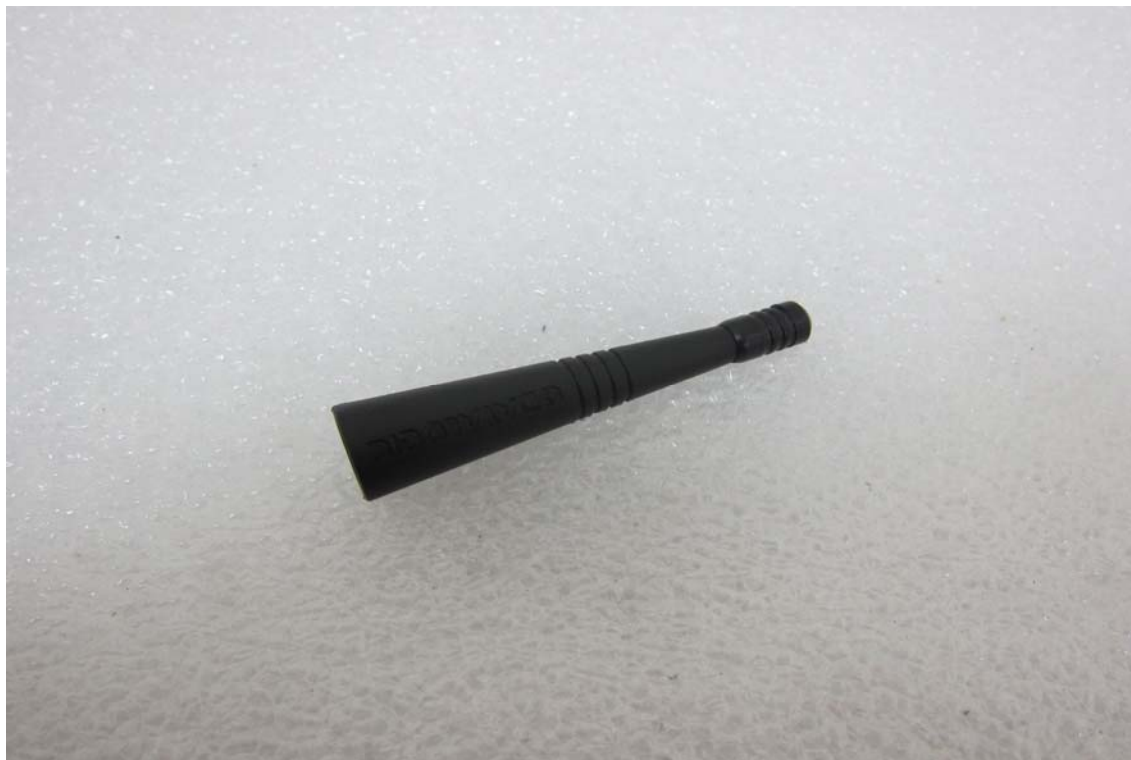
EUT – 6 (Rubber Antenna, P/N: G-RA0K14155047-BON)
