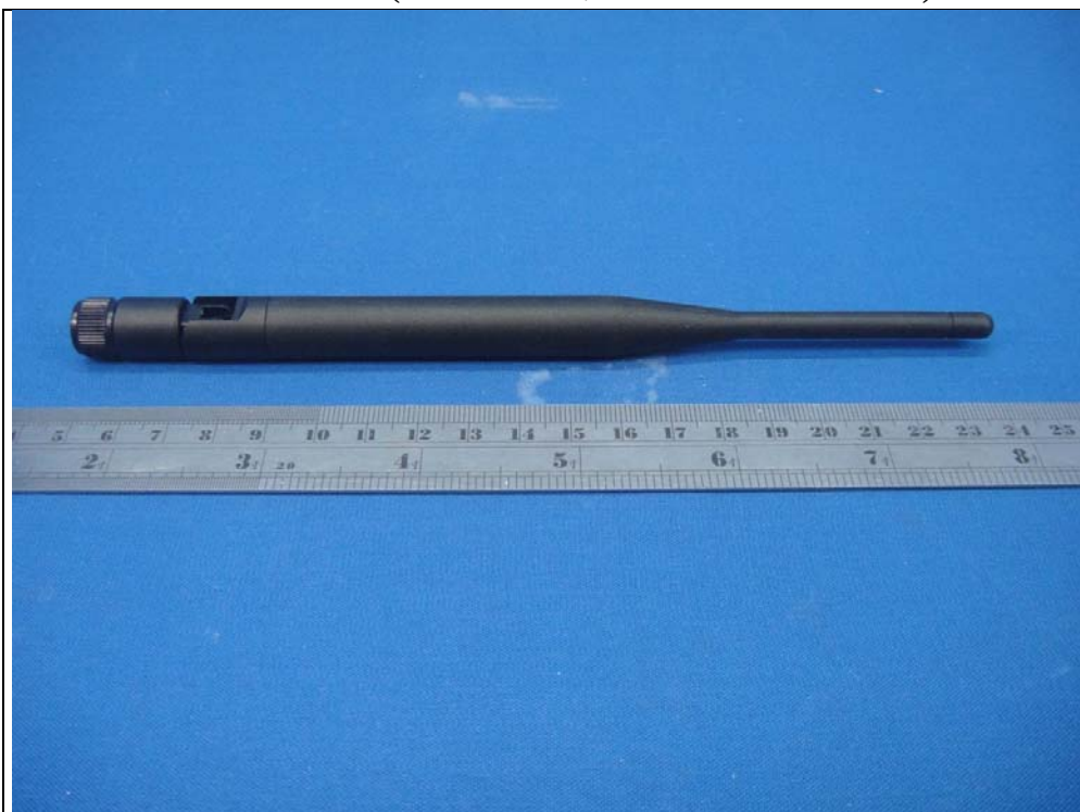
WLAN antenna (Brand: WNC, Model : 9E.XCI15.001)
