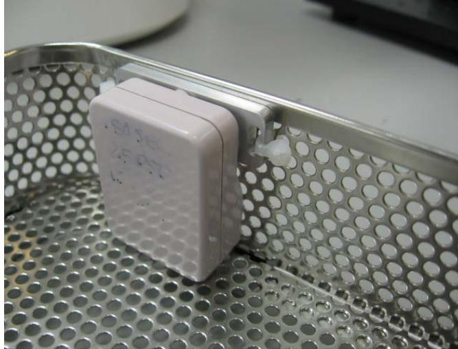
Figure 74 - Sterilizable Tag Installation
