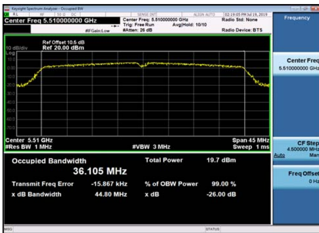
U-NII-2c 99% Bandwidth-802.11ac(40MHz) ,5670MHz
