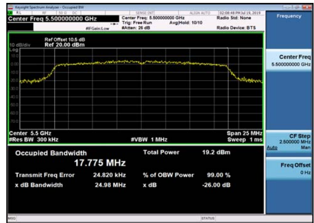
U-NII-2c 99% Bandwidth-802.11ac(20MHz) ,5700MHz
