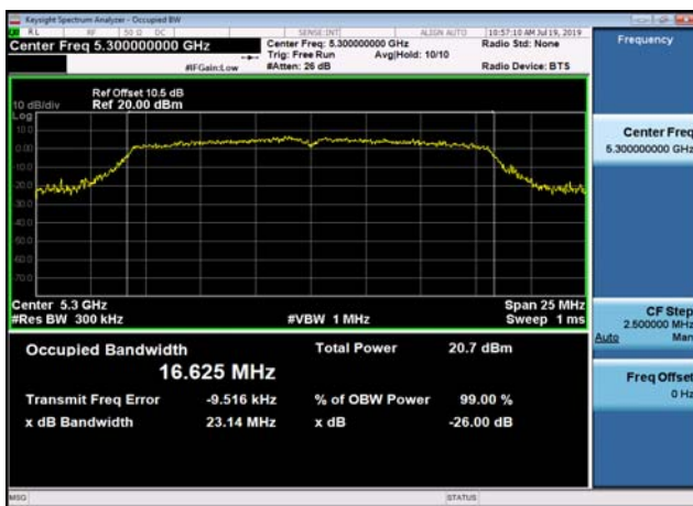
U-NII-2a 99% Bandwidth-802.11ac(20MHz) ,5260MHz
