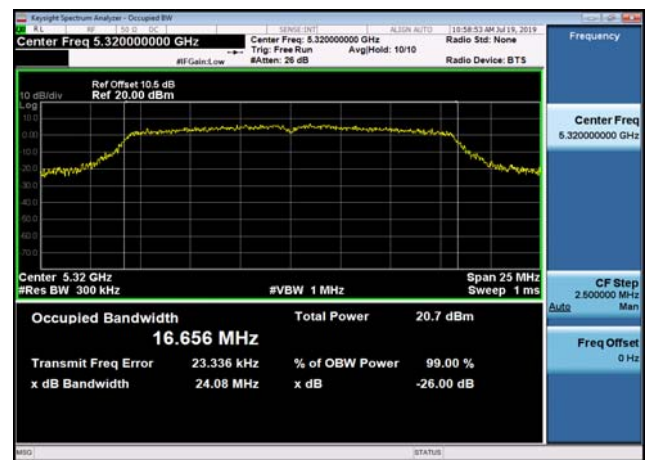
U-NII-2a 99% Bandwidth-802.11ac(20MHz) ,5300MHz
