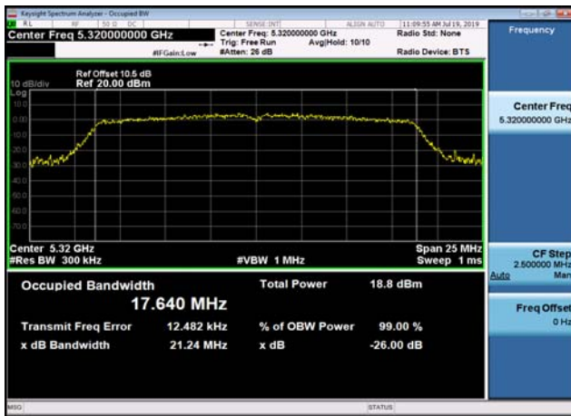
U-NII-2a 99% Bandwidth-802.11ac(40MHz) ,5310MHz
