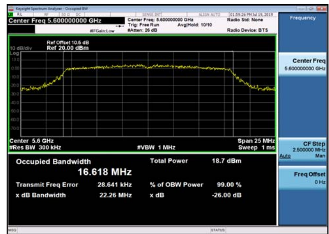
U-NII-2c 99% Bandwidth-802.11ac(20MHz) ,5500MHz
