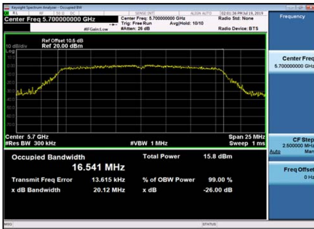
U-NII-2c 99% Bandwidth-802.11ac(20MHz) ,5600MHz
