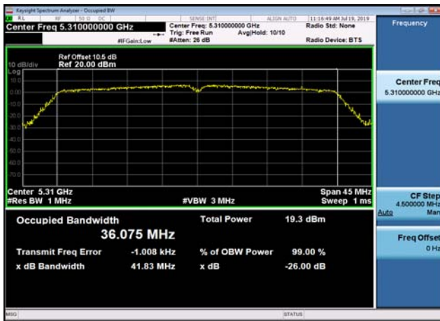
U-NII-2a 99% Bandwidth-802.11ac(40MHz) ,5310MHz
