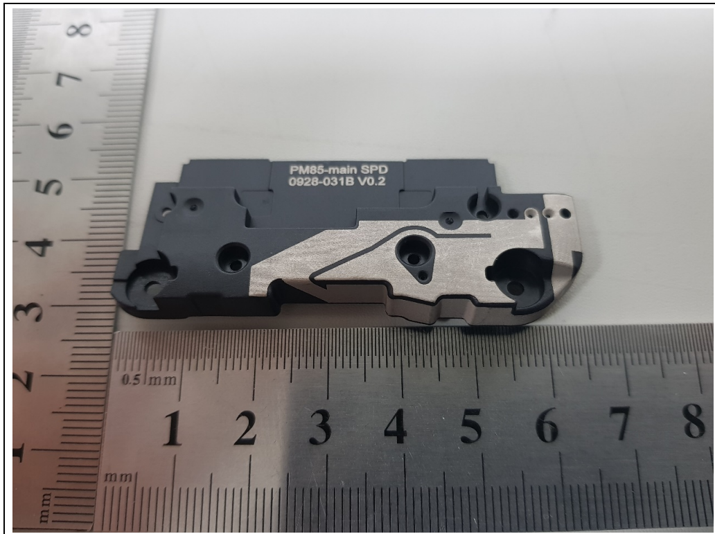
<Main GSM/WCDMA/LTE Antenna>
