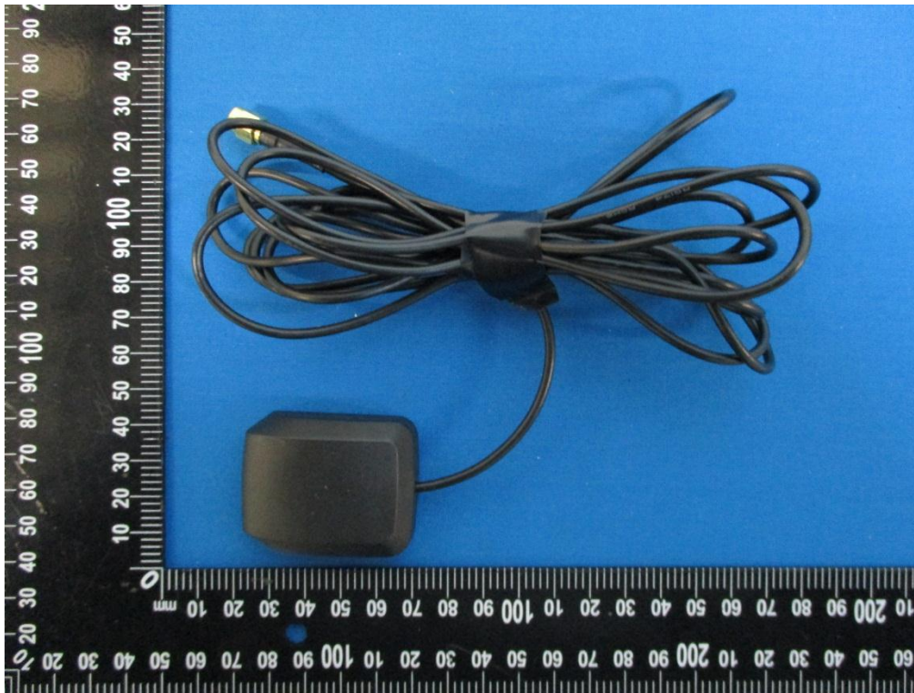
EUT - GPS Antenna
