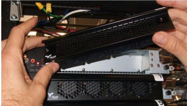
Figure 2-6. IRU 600v3 Fan Removal
