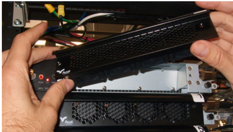
Figure 41. IRU 600v3 Fan Tray Removal
